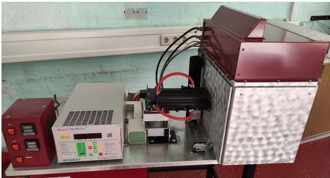
Slika 42. Peć za hibridno mikrovalno sinteriranje
