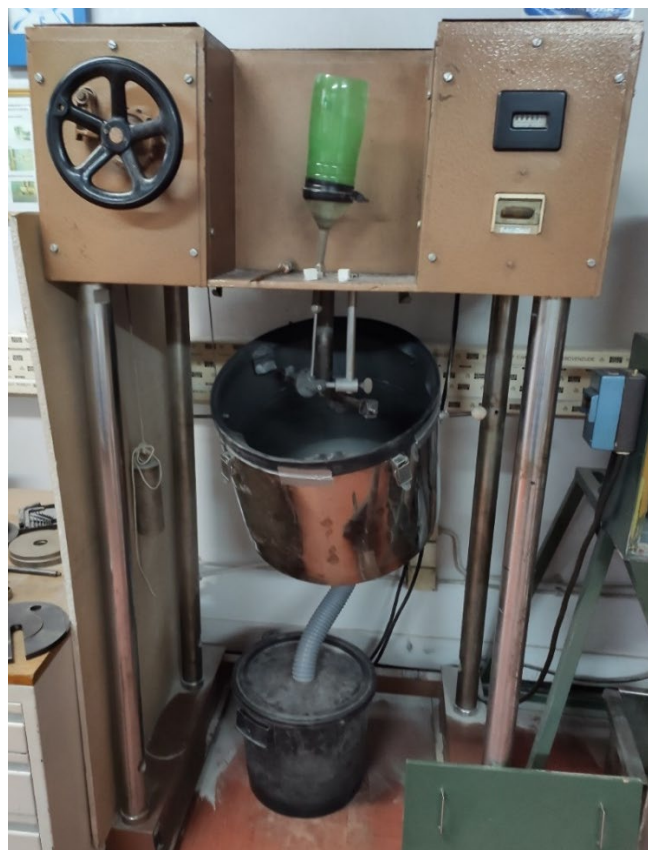
Slika 45. Uređaj za ispitivanje otpornosti na eroziju česticama
