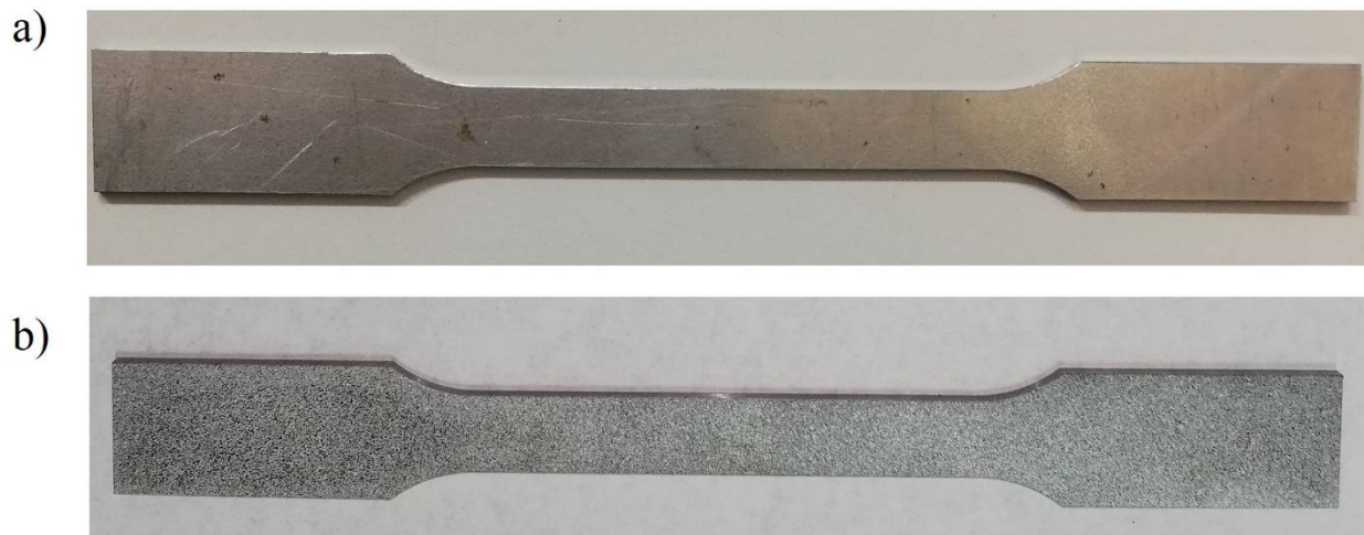
Slika 13. Površina ispitnog uzorka prije (a) i poslije nanošenja teksture (b)
