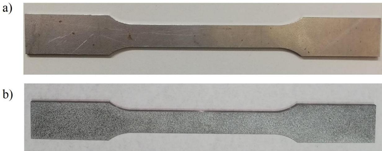
Slika 13. Površina ispitnog uzorka prije (a) i poslije nanošenja tekture (b)
