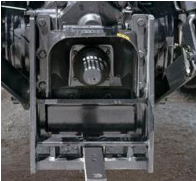
Slika 8. Izlazni priključak za radno vratilo
