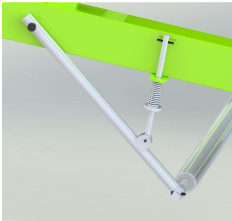
Slika 37. Sustav pritiskanja folije za podlogu
