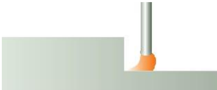
Slika 5. Puhanje električnog luka uslijed različitih debljina radnih komada koji se zavaruju [4]
