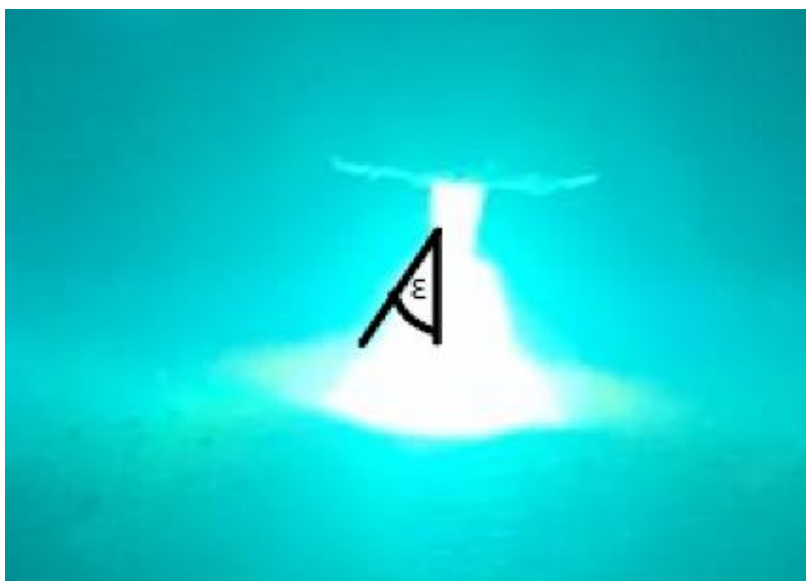
Slika 39. Otklon električnog luka za poziciju 5 (kut \varepsilon=30^\circ )
