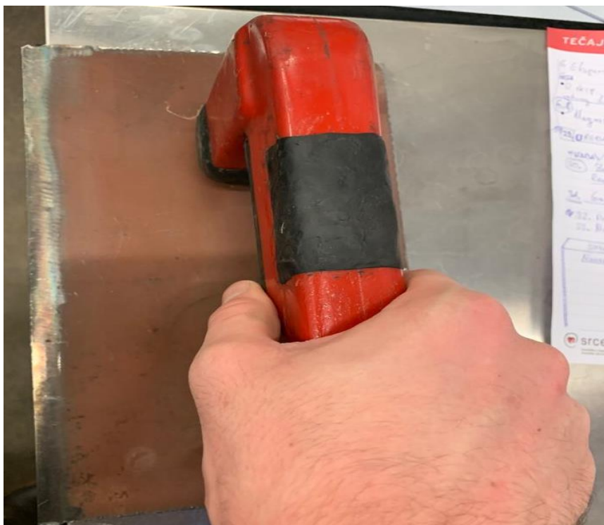
Slika 29. Provođenje magnetizacije magnetnim jarmom
