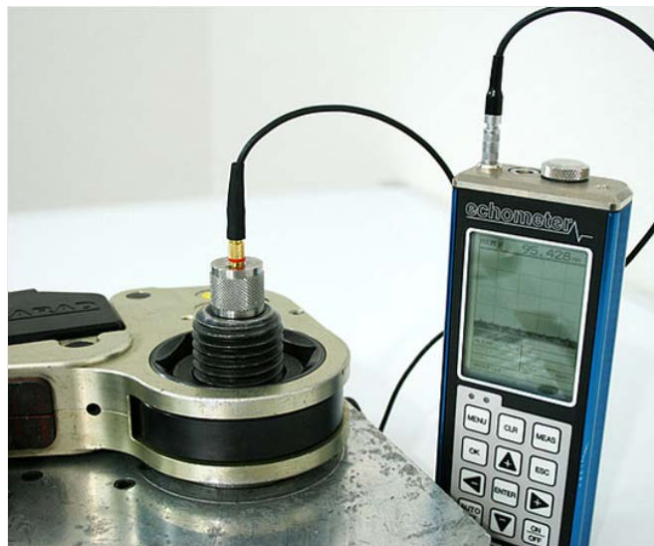
Slika 25. Mjerenje sile u vijku s pomoću ultrazvuka [10]
