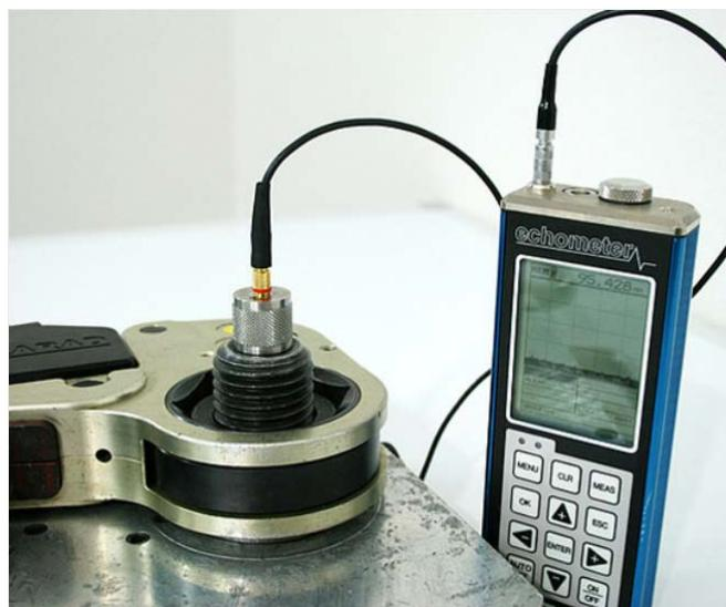
Slika 25. Mjerenje sile u vijku s pomoću ultrazvuka [10]
