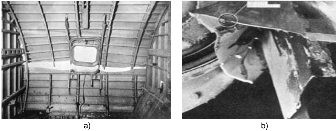
Slika 2.3. Kolaps trupa na ispitivanom modelu Comet G-ALYU; a) pogled iznutra, b) pogled izvana
