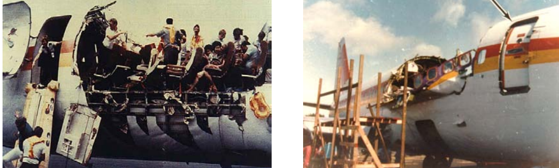
Slika 2.10. Oštećenja na Aloha Airlines 737
