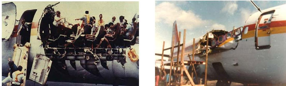
Slika 2.10. Oštećenja na Aloha Airlines 737
