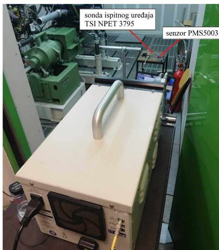
Slika 38. Ispitni uređaj za usporedno mjerenje lebdjećih čestica
