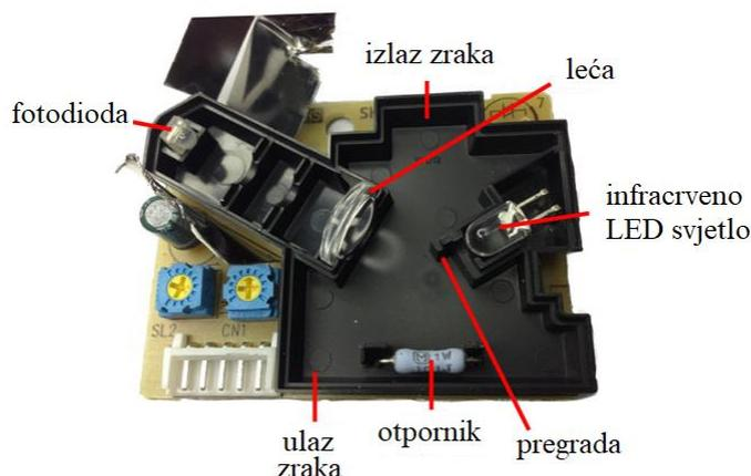
**Slika 16. Unutrašnjost optičkog PM<sub>2,5</sub> senzora PPD42NS [41]**
