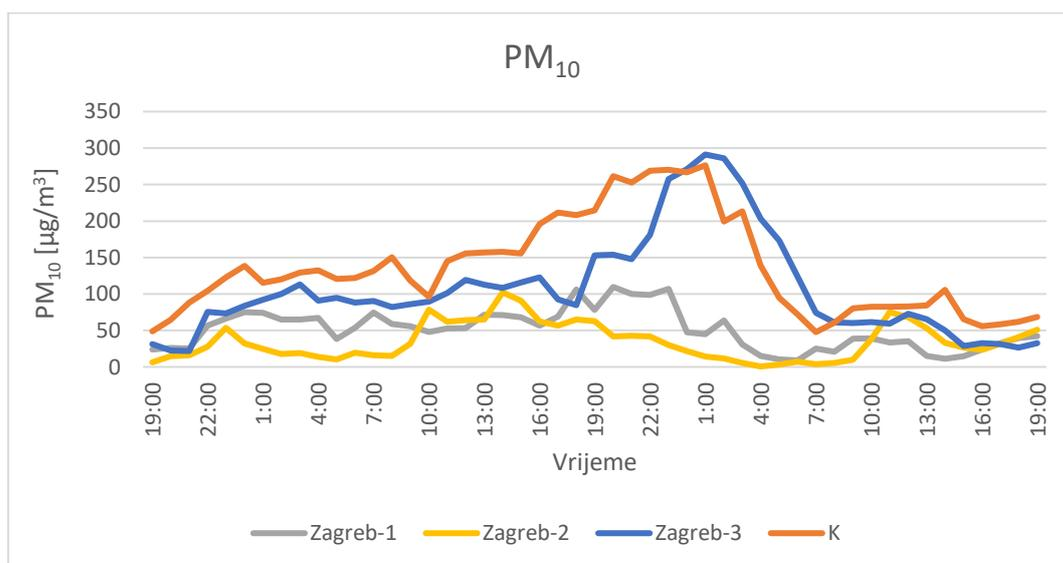
Slika 58. Koncentracije PM<sub>10</sub> četvrtog mjerenja
