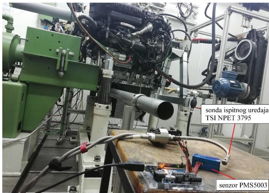
**Slika 39. Pozicioniranje senzora za usporedno mjerenje lebdećih čestica**
