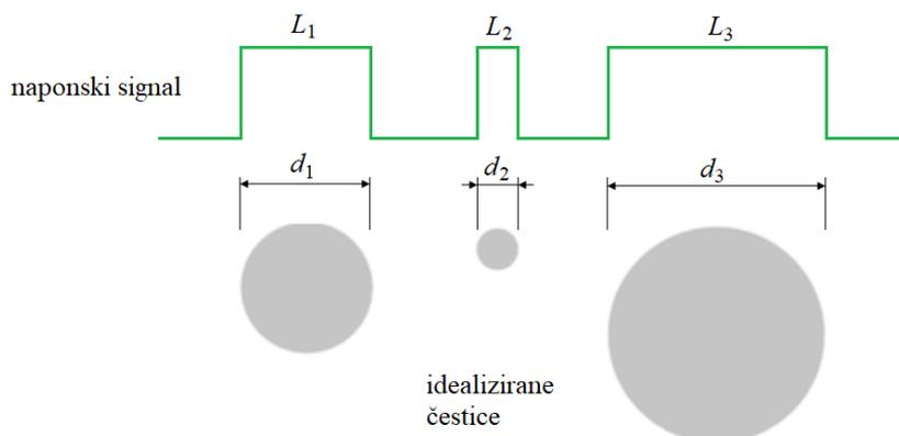
**Slika 18. Naponski signal fotodiode za čestice različitih promjera [40]**
