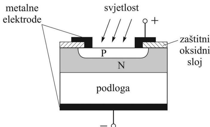
**Slika 17. Shema fotodiode [42]**
