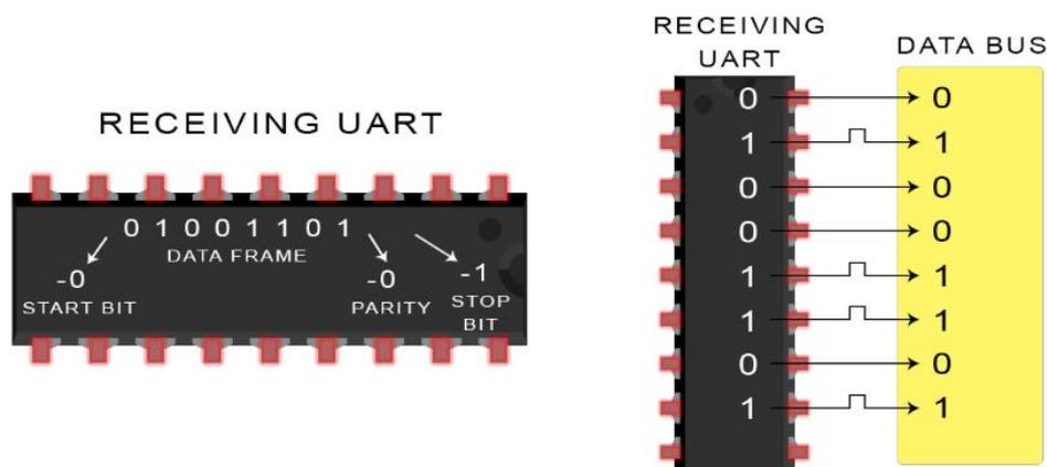
Slika 32. Pretvorba podatka i slanje upravljačkoj jedinici [46]
