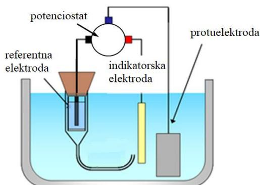
Slika 13. Shematski prikaz troelektrodnog elektrochemijskog senzora [33]
