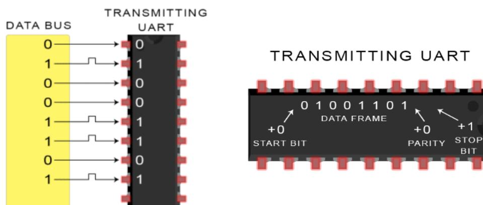
Slika 30. Primanje podatka od upravljačke jedinice i pretvorba [46]
