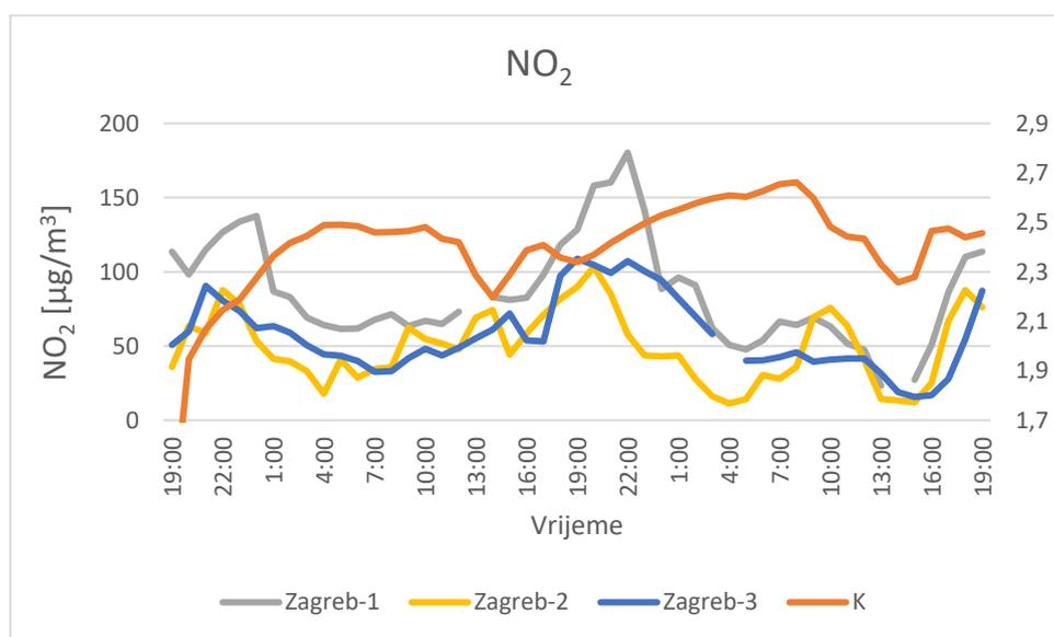
**Slika 59. Koncentracije  $NO_2$  četvrtog mjerenja**
