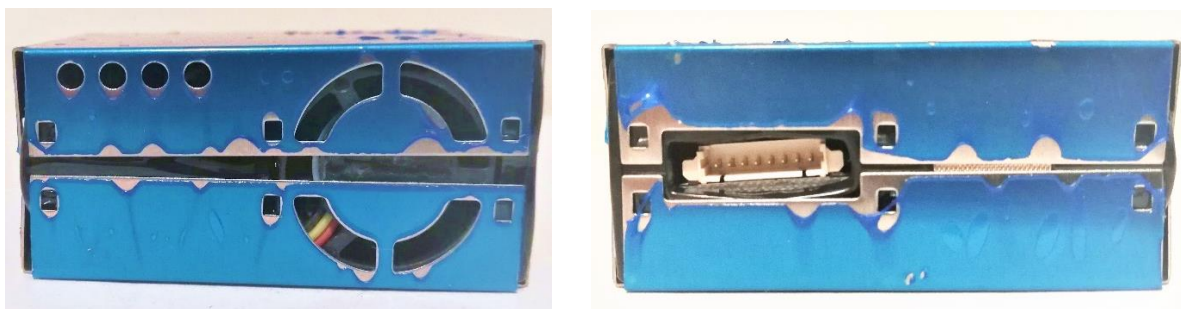
Slika 50. Deformirano kućište PMS5003 uređaja u frontalnom (lijevo) i stražnjem (desno) pogledu
