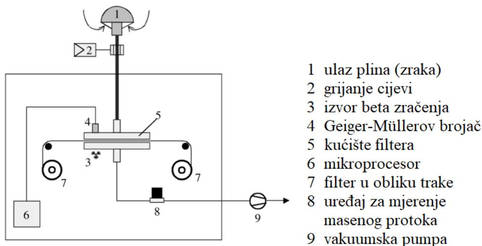
Slika 6. Shematski prikaz uređaja s atenuacijom beta zračenja [21]
