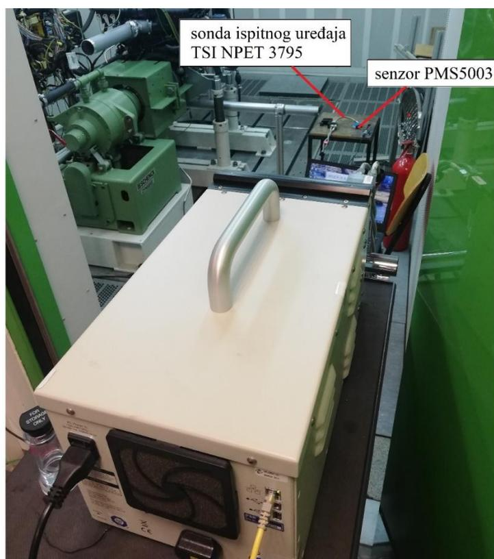
Slika 38. Ispitni uređaj za usporedno mjerenje lebdećih čestica
