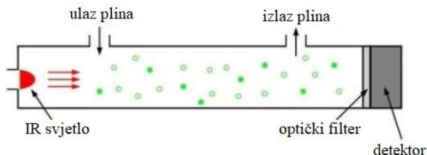
Slika 10. NDIR CO<sub>2</sub> senzor [28]
