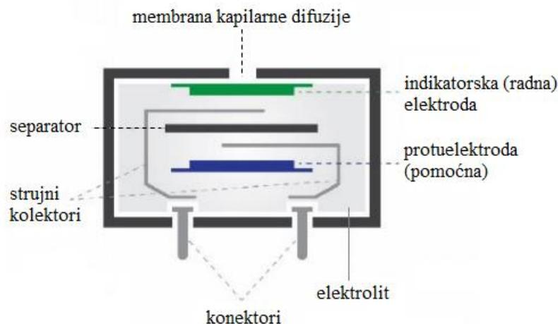
Slika 12. Shematski prikaz elektrochemijskog senzora [33]
