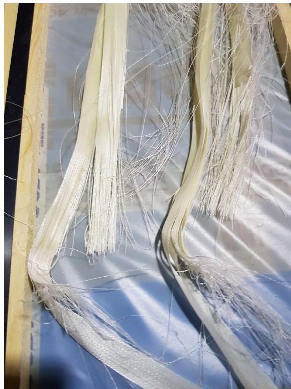
Slika 69. Naknadno pucanje staklenih niti prilikom ispitivanja na testnoj jezgri
