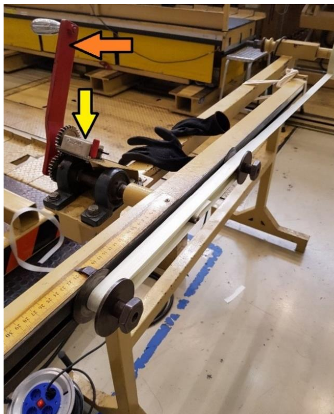
Slika 40. Detalj naprave za namatanje steznih elemenata
