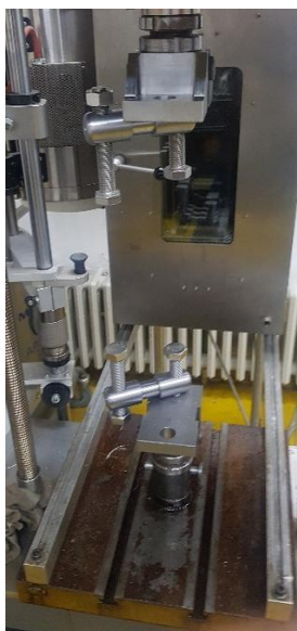
Slika 50. Prihvati u položaju za izmjenu uzorka
