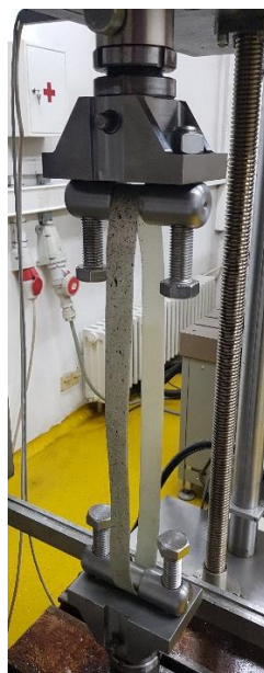
Slika 51. Uzorak pozicioniran na kidalici
