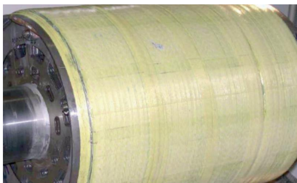
Slika 38. Polyglas® traka iskorištena kao bandaža rotora generatora [35]
