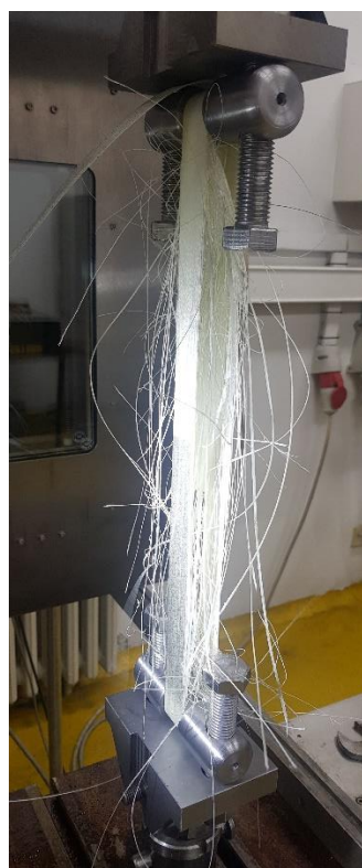
Slika 67. Pucanje vlakana u unutrašnjim slojevima
