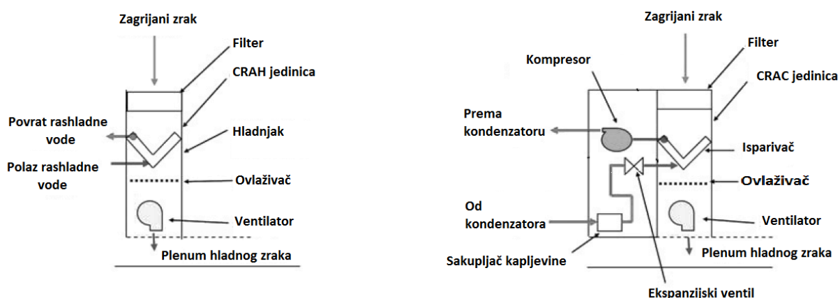
Slika 13. CRAH i CRAC jedinice [6]
