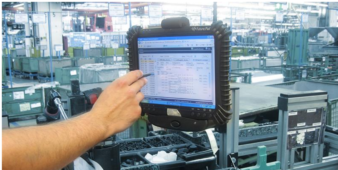
Slika 38. Primjer industrijskog tableta na radnom mjestu [25]
