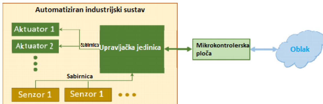
Slika 4. Proširenje sustava pomoću ploče mikrokontrolera [6]
