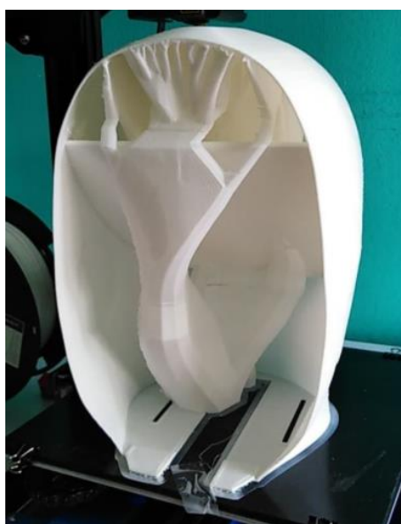
Slika 95. Izrada stražnjeg dijela glave na 3D printeru
