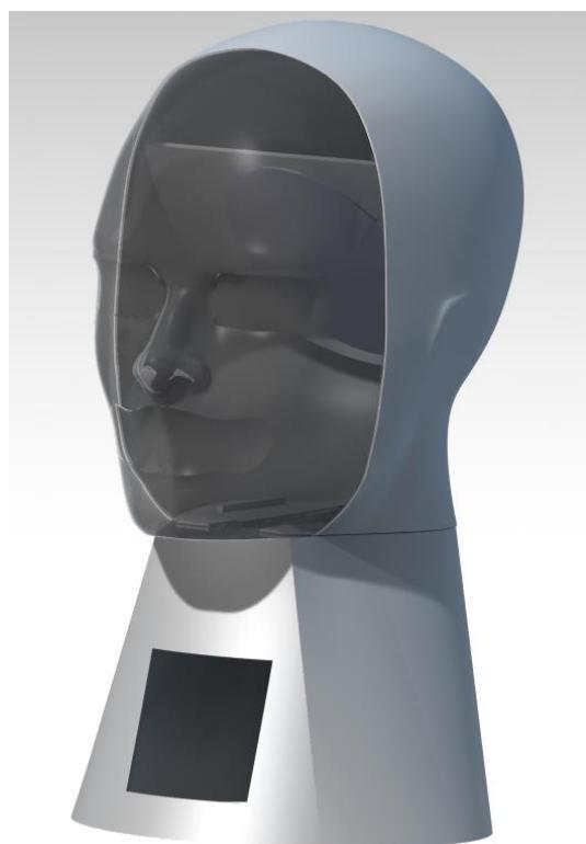
**Slika 93.** Sklop druge verzije glave afektivnog robota
