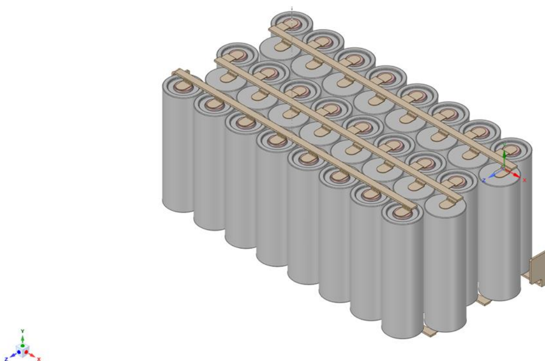
Slika 4.3 Serijski i paralelni spoj ćelija u modulu
