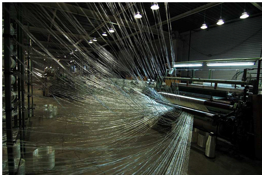
Slika 5 Primjer izrade staklenih vlakana [18]
