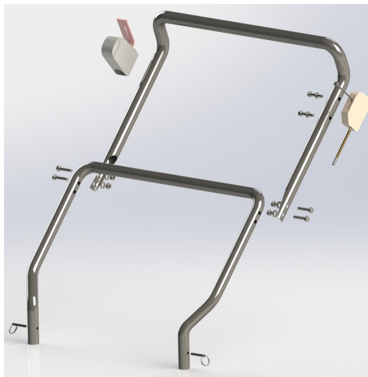
Slika 8.14: Sklop ručke u rastavljenom obliku
