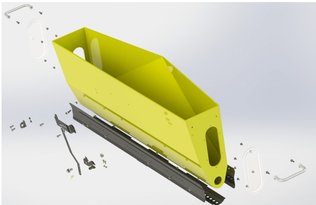
Slika 8.9: Sklop posude u rastavljenom obliku 1
