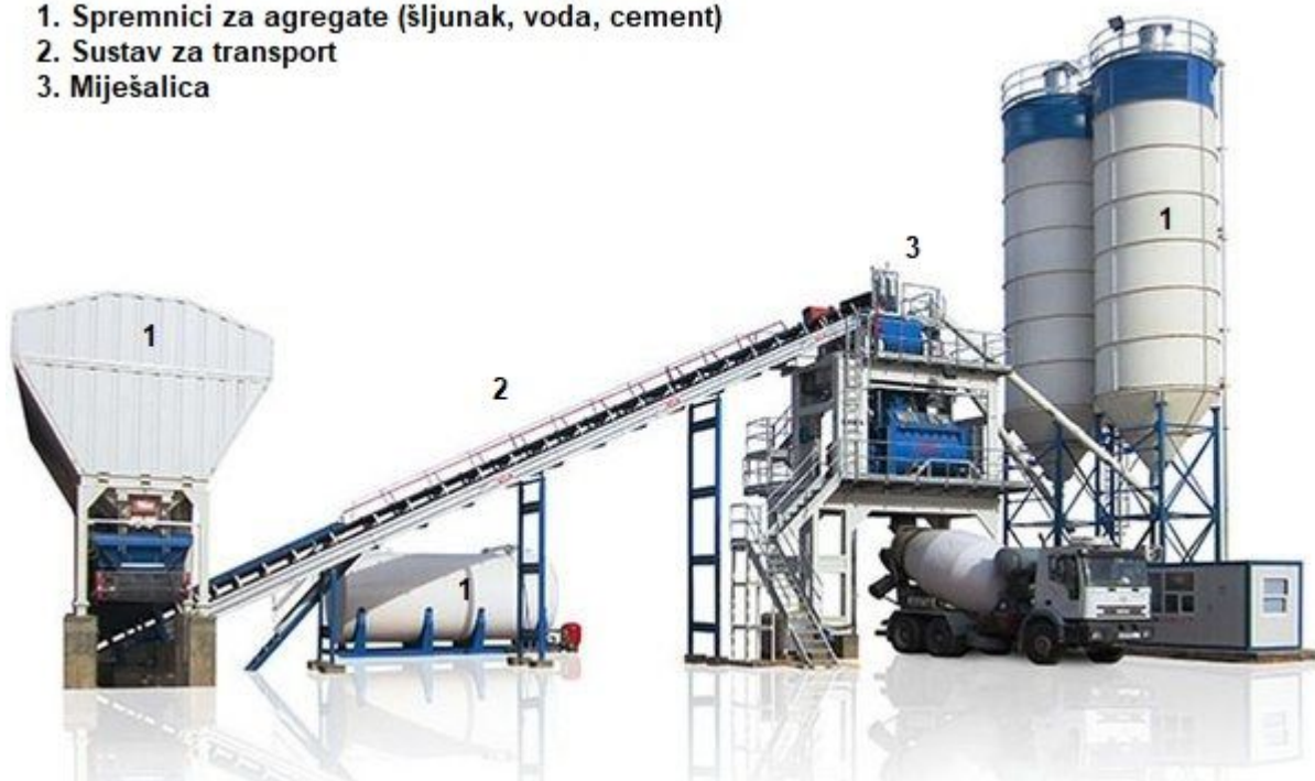
Slika 2. Betonara sa rednim silosima
