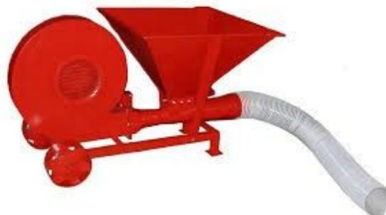
Slika 10. Pneumatsko prenosilo
