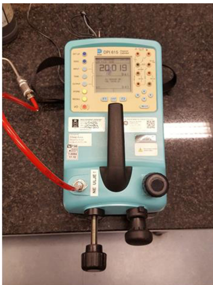
Slika 21. Pretvornik tlaka s kalibratorom Druck DPI 615 – prijenosni etalon
