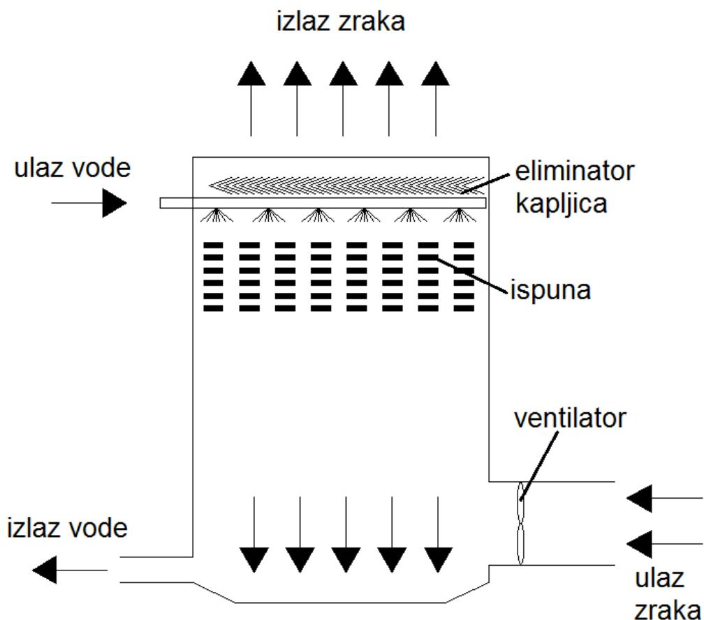
Slika 7. Rashladni toranj s tlačnim, protustrujnim strujanjem (adaptirano iz [2])
