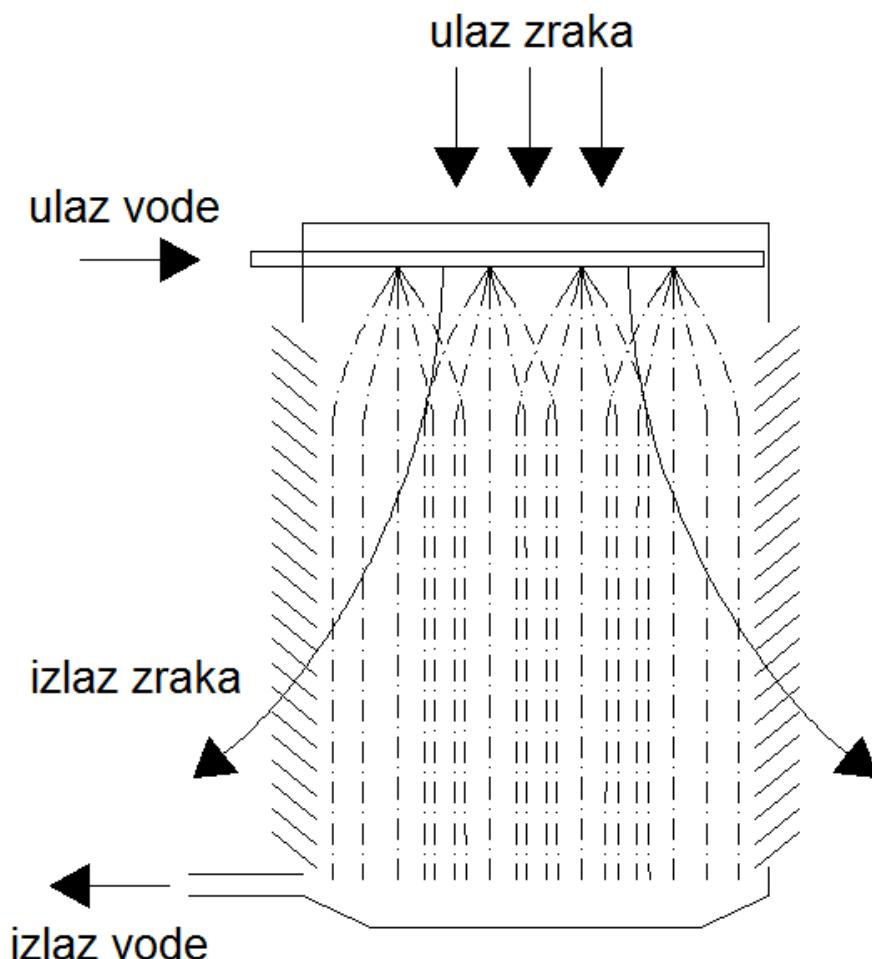
Slika 6. Indukcijski atmosferski toranj (adaptirano iz [2])
