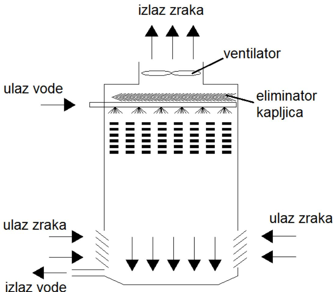
Slika 9. Rashladni toranj s induciranim protustrujnjim strujanjem
