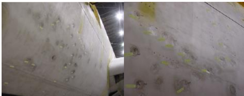
Slika 12. Udubine na trupu zrakoplova [12]
