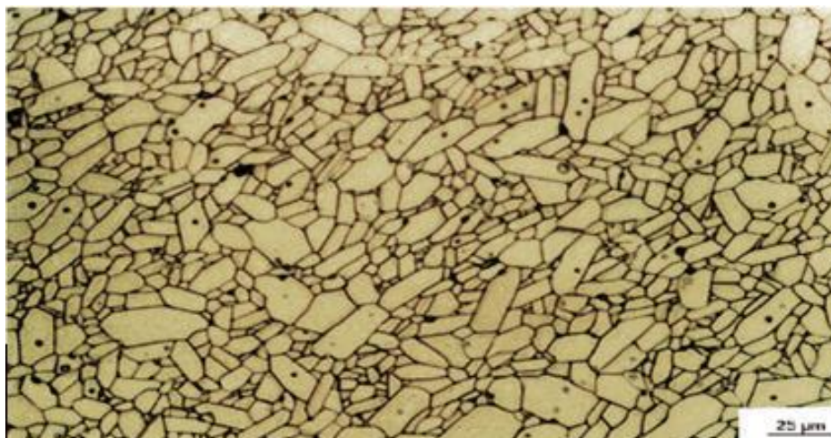
Slika 17. Mikrostruktura sinterirane aluminijske oksidne keramike [15]
