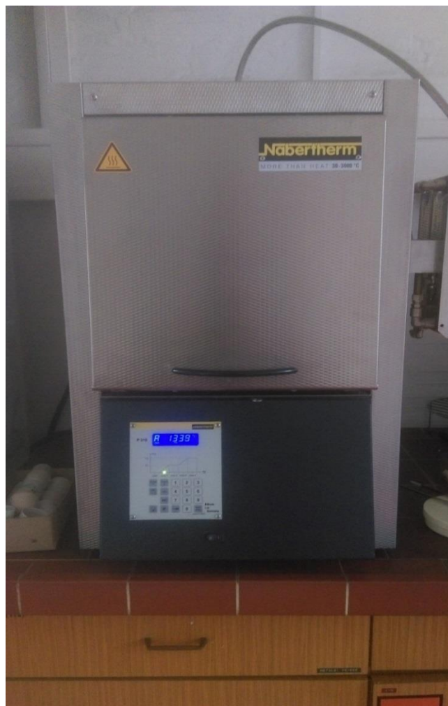
Slika 31. Električna peć za sinteriranje
