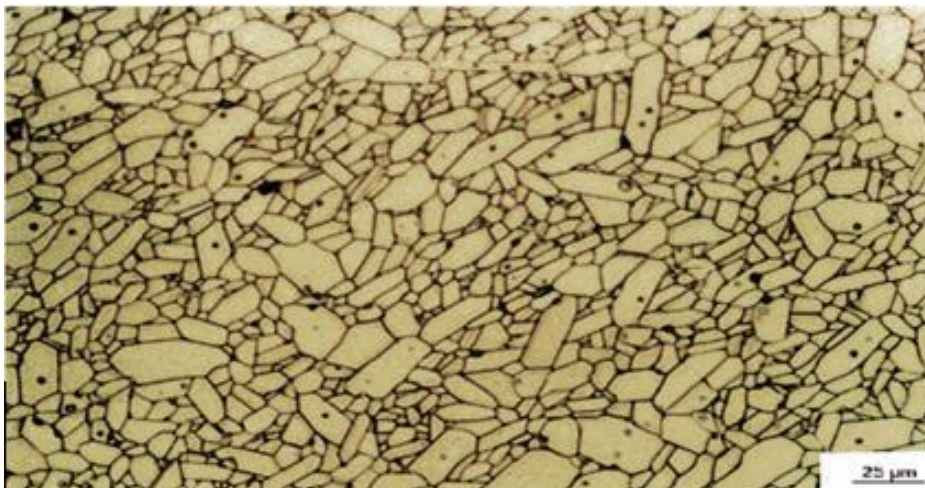
Slika 17. Mikrostruktura sinterirane aluminijske oksidne keramike [15]
