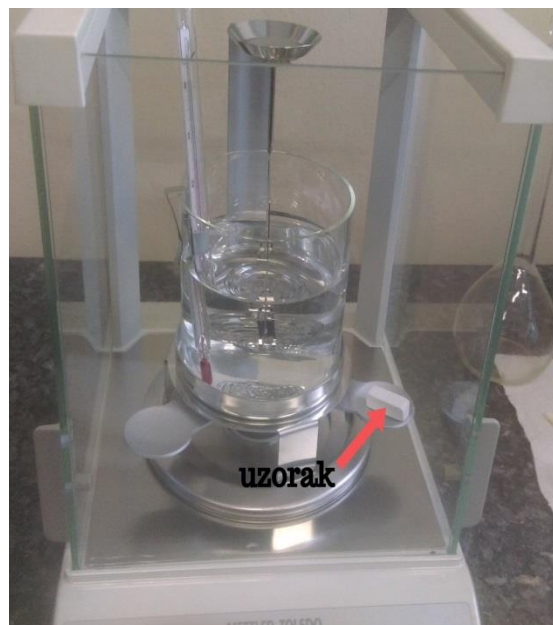
Slika 35. Mjerenje mase uzorka na zraku
