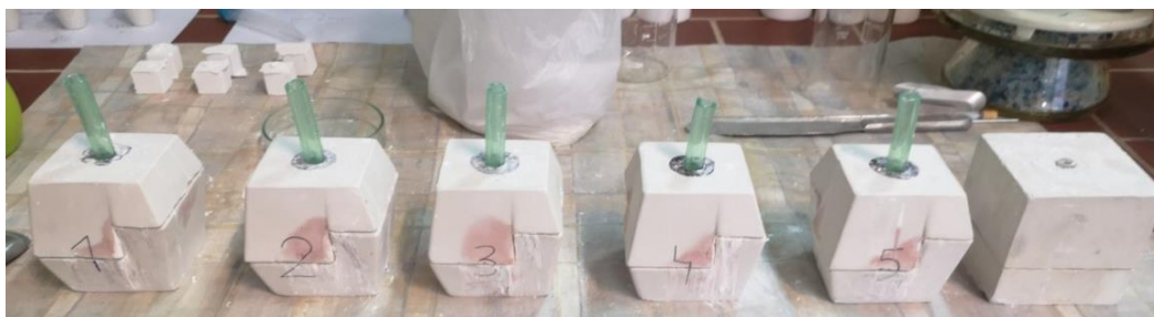
Slika 25. Gipsani kalupi za lijevanje suspenzije
