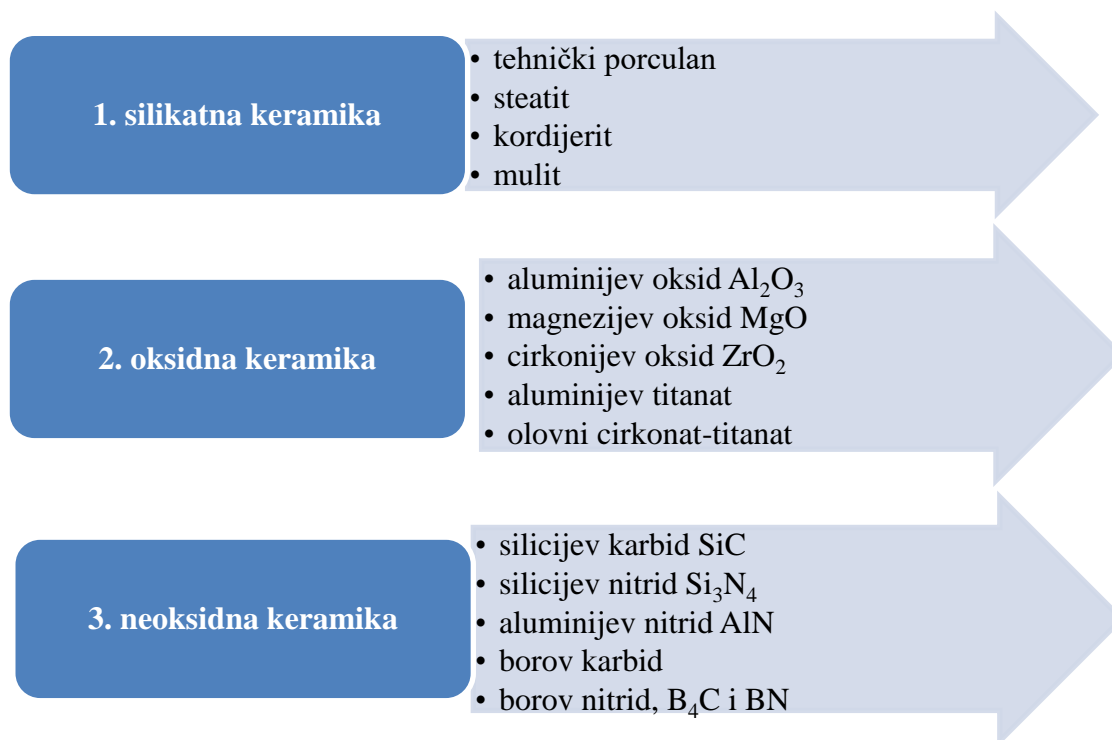
Slika 6. Shematski prikaz podjele tehničke keramike prema kemijskom sastavu [4]
