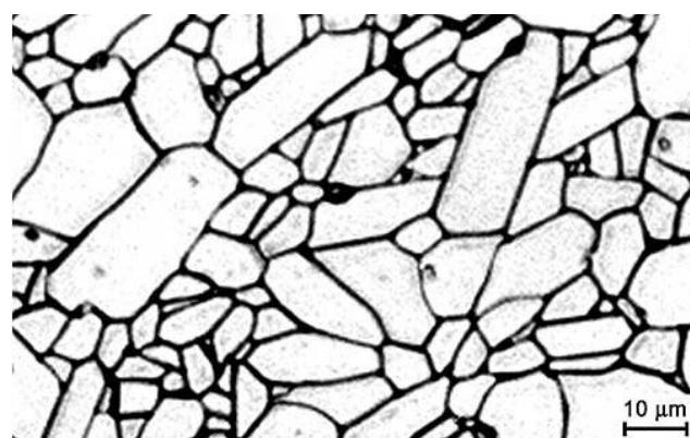
**Slika 10. Mikrostruktura  $\text{Al}_2\text{O}_3$  keramike (99,7 %) [8]**
