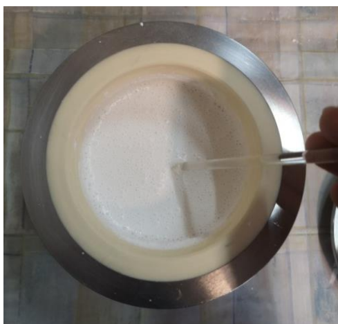
Slika 21. Miješanje i dodavanje ostalih sastojaka za dobivanje potrebne suspenzije
