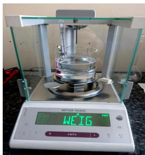
Slika 35. Mjerenje mase uzorka Al<sub>2</sub>O<sub>3</sub> na zraku
