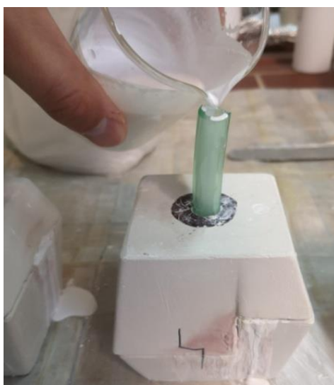
Slika 26. Ulijevanje suspenzije u gipsani kalup
