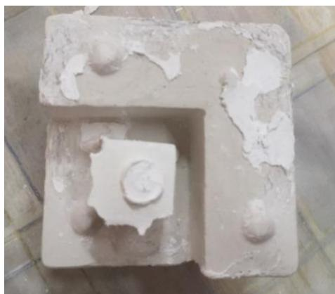
Slika 27. Otvaranje gipsanih kalupa te čišćenje sirovaca
