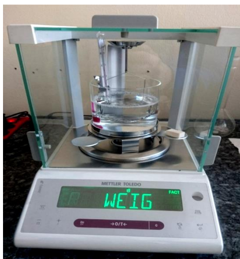
Slika 35. Mjerenje mase uzorka \text{Al}_2\text{O}_3 na zraku
