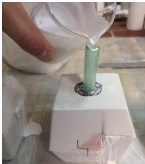
Slika 26. Ulijevanje suspenzije u gipsani kalup
