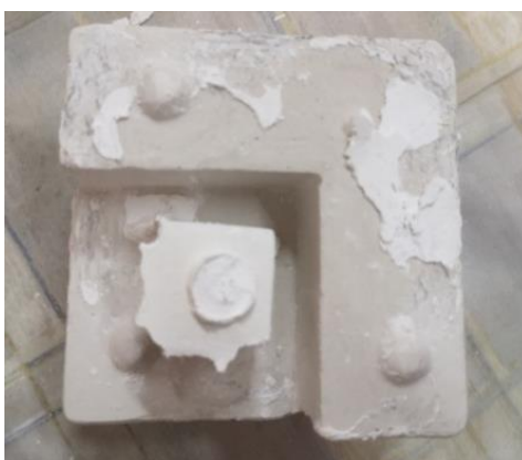
Slika 27. Otvaranje gipsanih kalupa te čišćenje sirovaca
