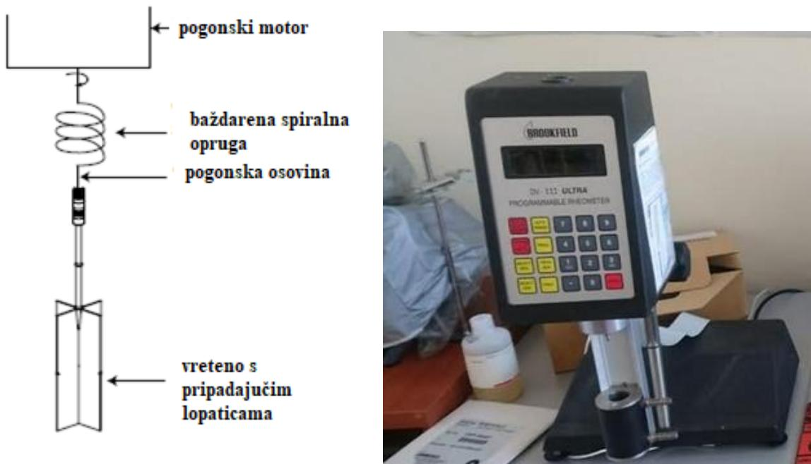
Slika 23. Shematski prikaz rotacijskog viskozimetra *Brookfield DV- III Ultra* [19]
