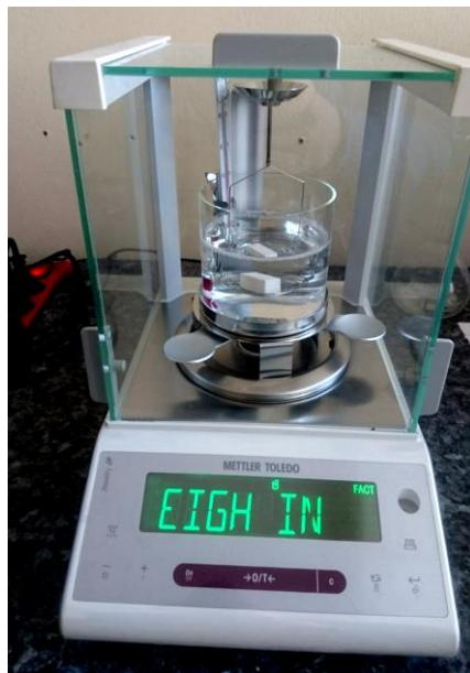
Slika 36. Mjerenje mase uzorka  $\text{Al}_2\text{O}_3$  u vodi
