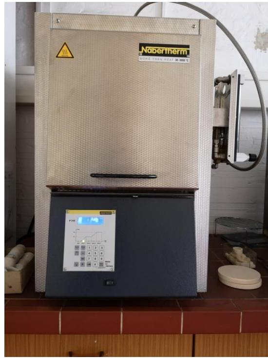
Slika 29. Laboratorijska peć za konvencionalno sinteriranje
