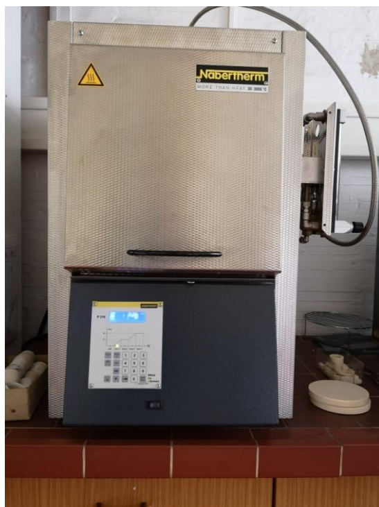
Slika 29. Laboratorijska peč za konvencionalno sinteriranje
