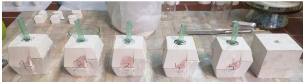
Slika 25. Gipsani kalupi za lijevanje suspenzije
