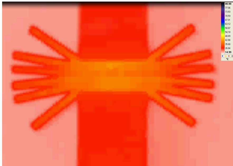
Slika 7.10: Temperatura izmjerena IR kamerom za brzinu deformiranja 10mm/s [9]
