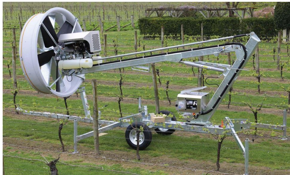
Slika 3.5. Tow and blow mobilni ventilator
