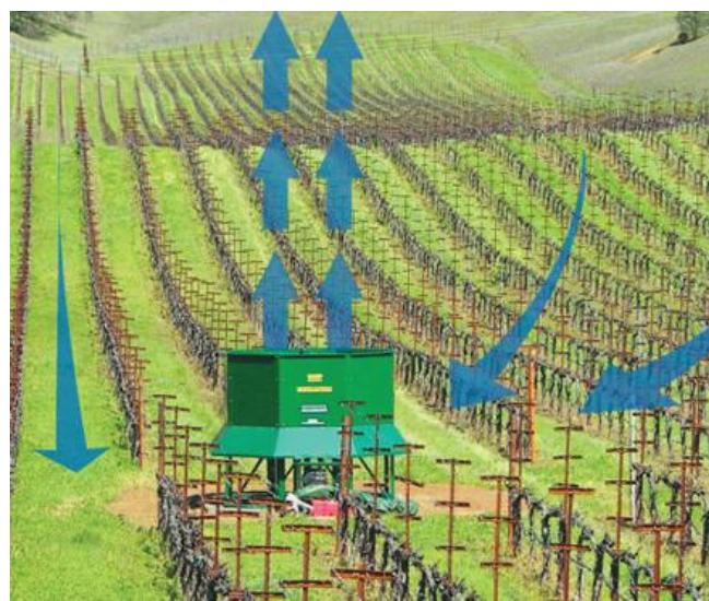
Slika 2.13. Vertikalni ventilator
