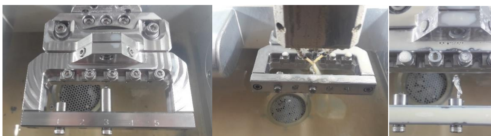
Slika 43. Predobradak stegnut u zahvatu prije početka obrade glodanjem (lijevo), tijekom glodanja (sredina) i nakon završetka obrade (desno)
