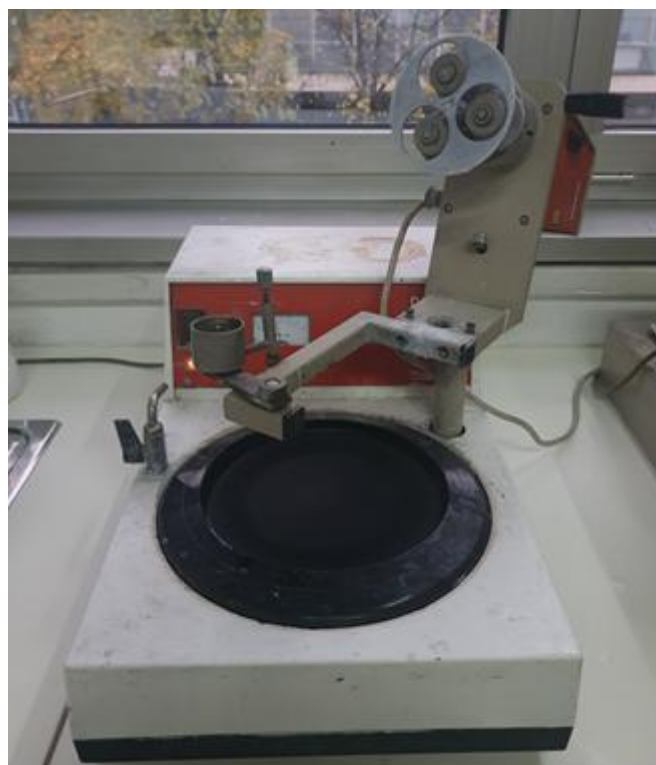
Slika 14. Uređaj za poliranje.
