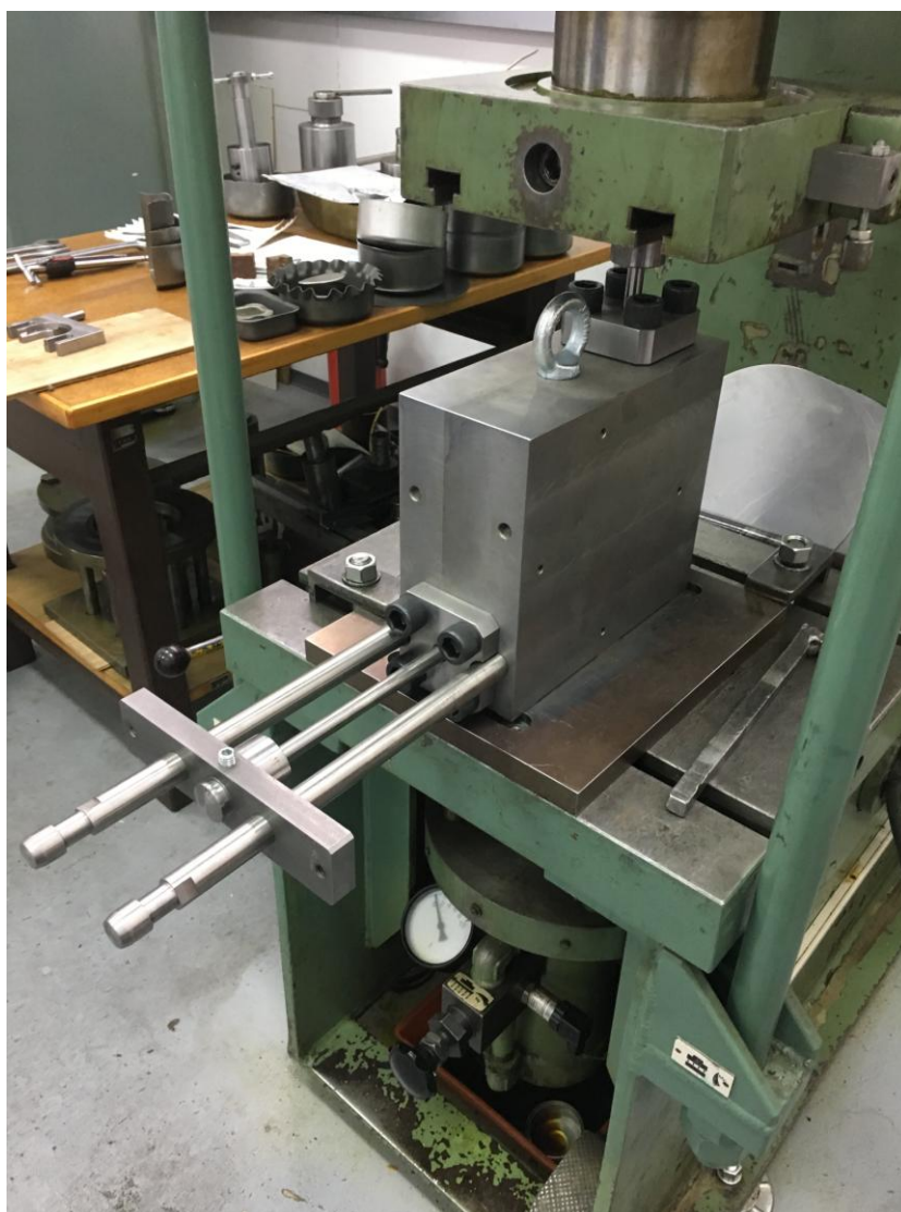
Slika 24. Alat i preša za ECAP -iranje.
