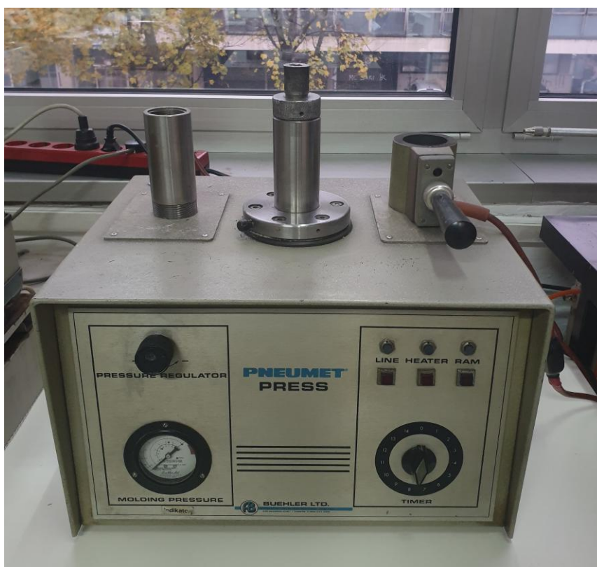
Slika 12. Uređaj za ulijevanje uzoraka u polimernu masu.
