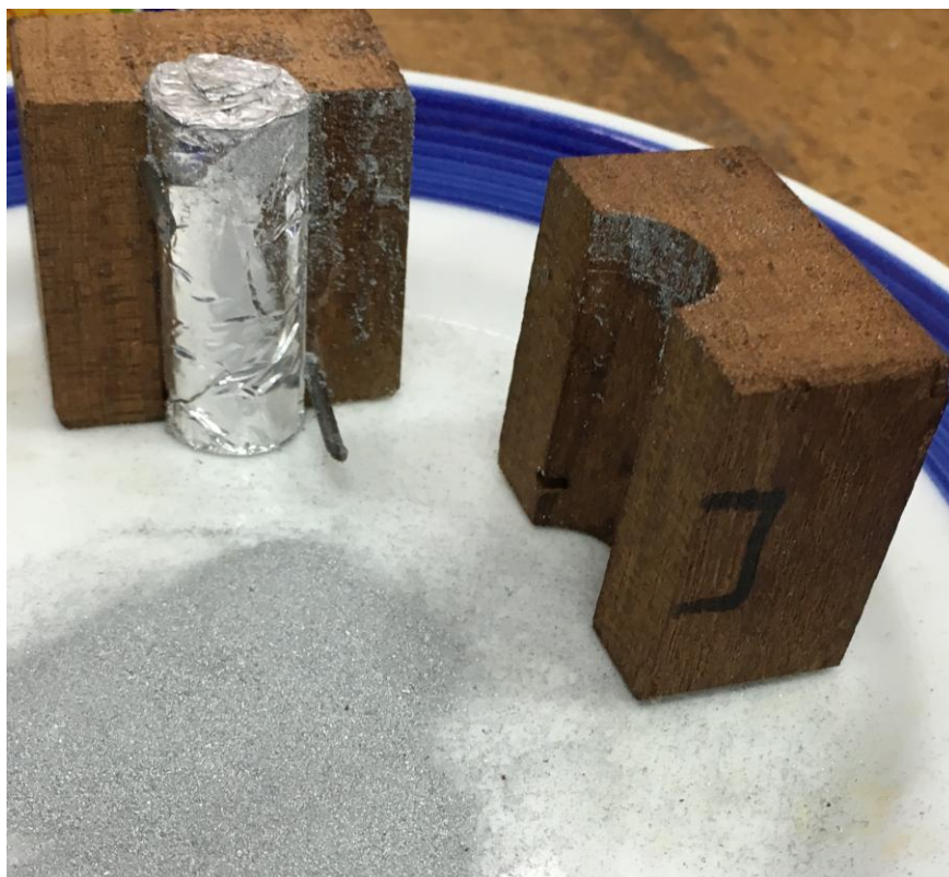
Slika 19. Prah zamotan u foliju pomoću drvenog kalupa.
