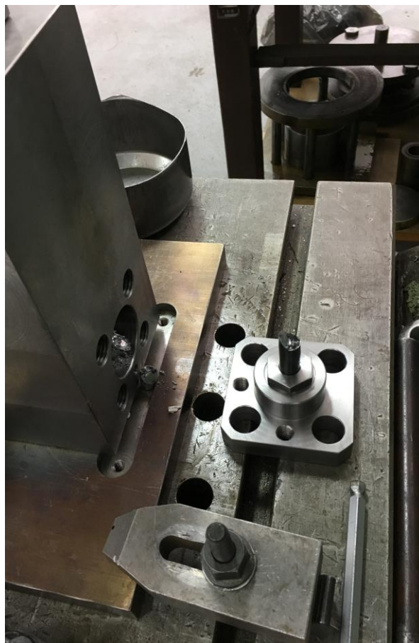
Slika 26. Izbacivanje ECAP-iranih uzoraka iz alata.
