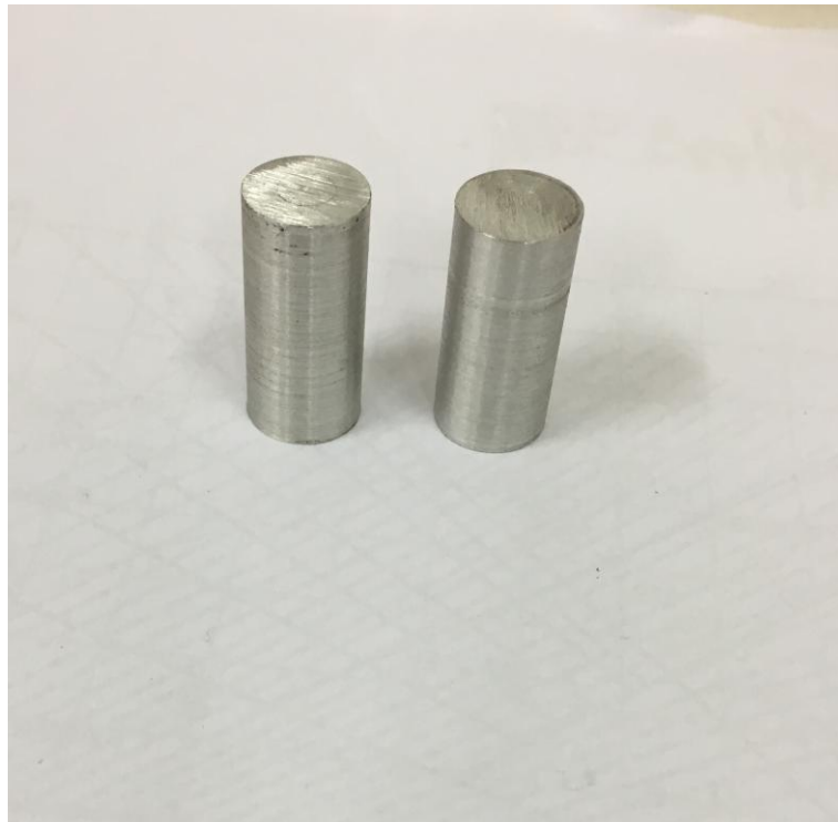
Slika 25. Aluminijski valjčići za ostvarenje protusile.
