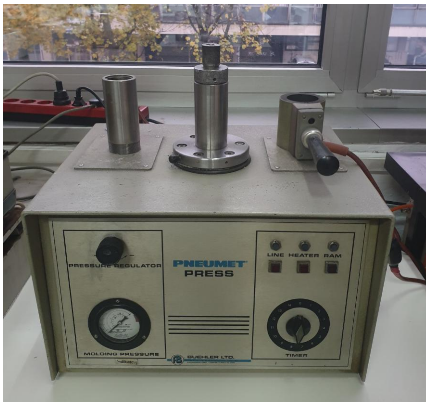
Slika 12. Uređaj za ulijevanje uzoraka u polimernu masu.
