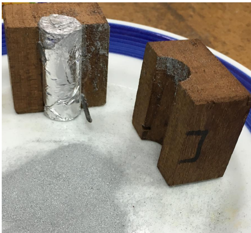
Slika 19. Prah zamotan u foliju pomoću drvenog kalupa.
