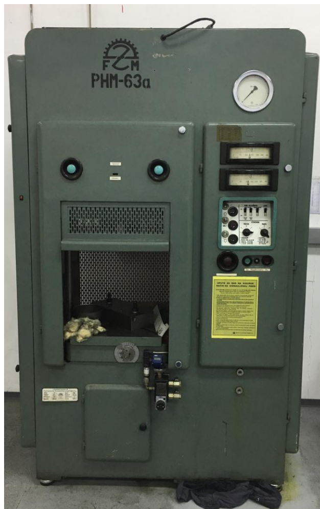
Slika 22. Preša korištena za CIP.
