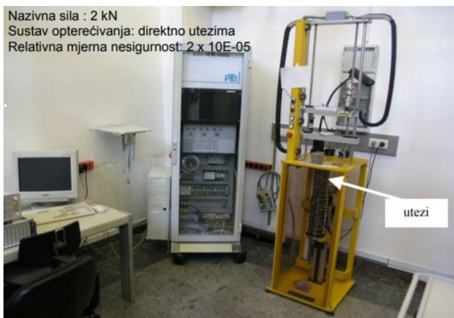
Slika 3 Nacionalni etalon sile Njemačke u PTB-u [4]
