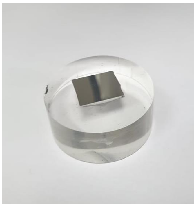
Slika 26 Uzorak uliven u polimernu masu
