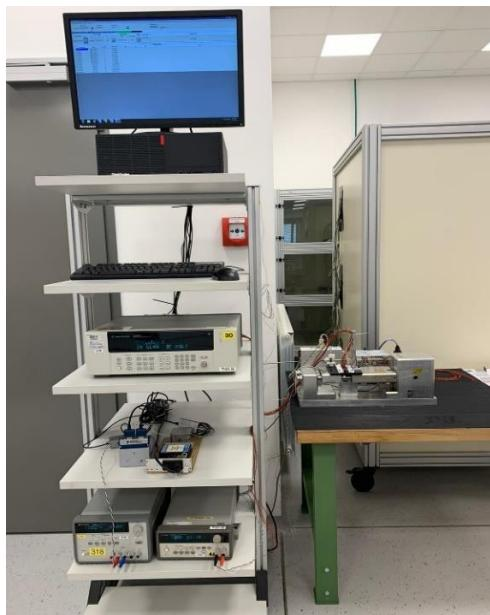
Slika 22. Stanica za fretting ispitivanje
