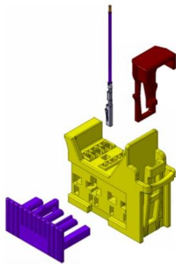
**Slika 9. Dijelovi kućišta konektora**
