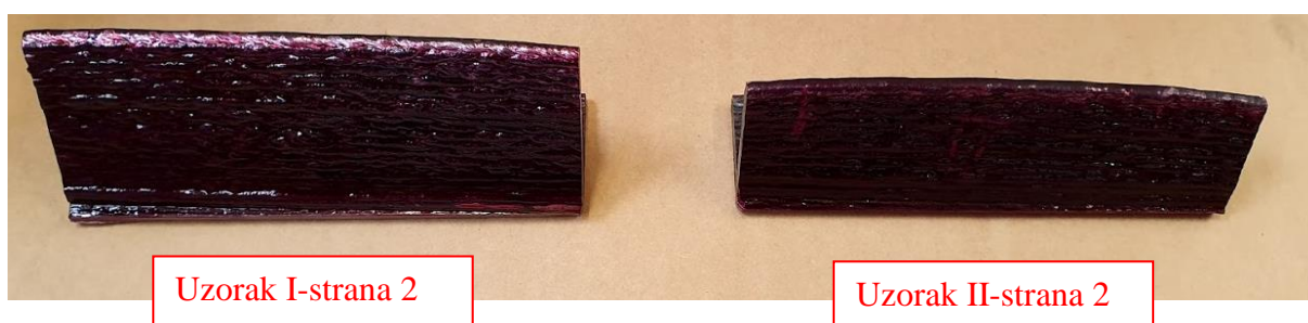
Slika 43. Strane 2 uzoraka nakon nanošenja penetranta
