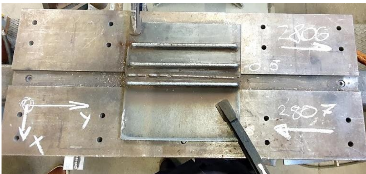
Slika 17. Stegnuta podložna ploča s naznačenim osima
