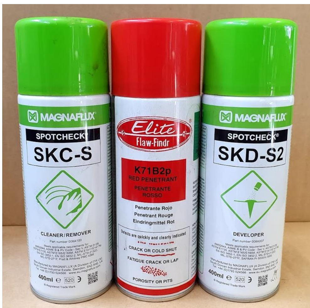
Slika 41. Sredstva korištena za penetrantsko ispitivanje
