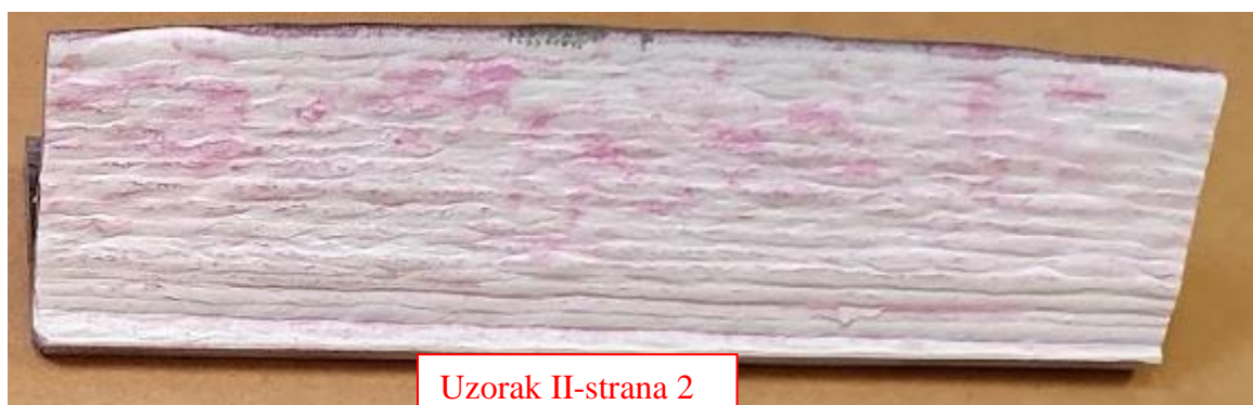
Slika 46. Rezultati penetrantske metode na strani 2 uzorka II
