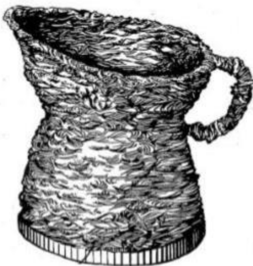
Slika 9. Prvi patent WAAM tehnologije [12]
