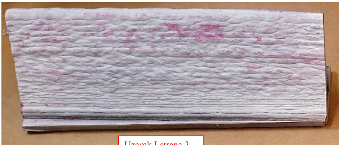
Slika 45. Rezultati penetrantske metode na strani 2 uzorka I
