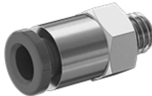
Slika 79. Ravni konektor, za plastične cijevi vanjskog promjera 4 mm, M5 x 0.8 mm [49]
