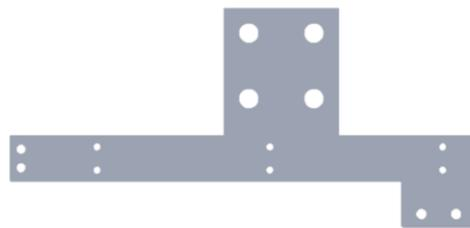
Slika 28. Tlocrt spojne ploče Schunkove prirubnice i linearog aktuatora
