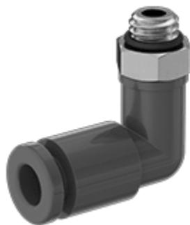
Slika 81. Konektor s laktom, za plastične cijevi vanjskog promjera 4 mm, M5 x 0.8 mm [49]
