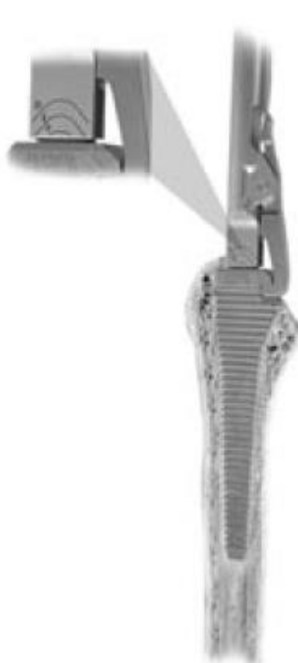
Slika 9. Priprema medularnog kanala [6]
