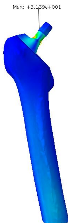
Slika 63. Naprezanja na modelu TCB
