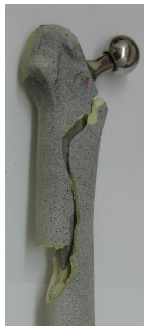
Slika 53. Periprostetički prijelom tipa B2
