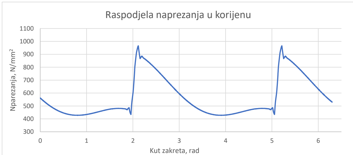
Slika 42. Graf raspodjele vlačnih naprezanja u korijenu zuba
