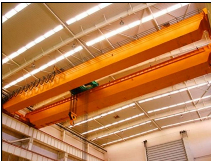
Slika 8. Mosni granik proizvođača Mingdao [10]
