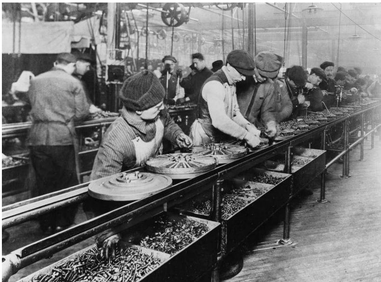
Slika 1. Masovna proizvodnja omogućena pokretnom trakom [5]
