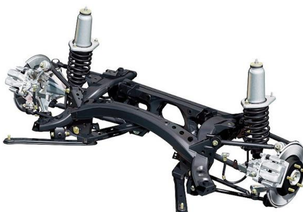
Slika 17. Hidrooblikovani stražnji okvir s ostalim komponentama modela Mazda MX-5 Roadster [19]
