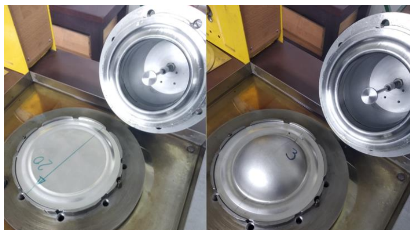
Slika 54. Rondela prije i nakon hidrauličkog udubljivanja
