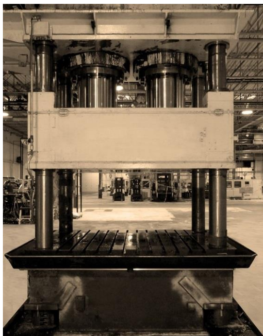
Slika 2. Preša za hidrooblikovanje proizvođača VariForm [4]
