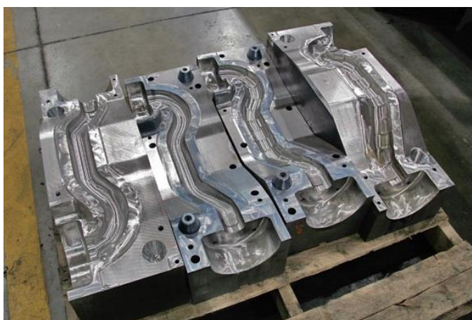
Slika 48. Kalup za hidrooblikovanje ispušnih komponenti automobila [39]
