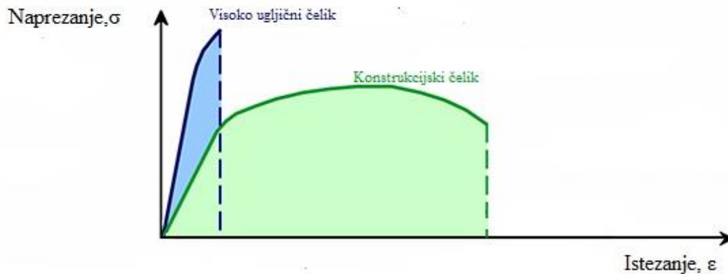
Slika 3. Usporedba žilavosti za dva različita materijala
