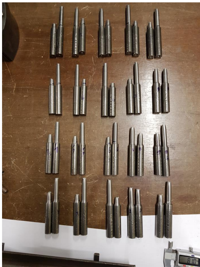
Slika 17. Prikaz slomljenih epruveta
