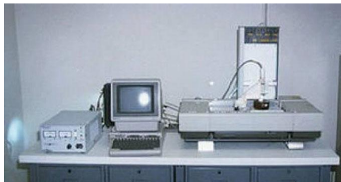
Slika 3. Prvi komercijalno raspoloživi sustav za aditivnu proizvodnju SLA-1 [3]
