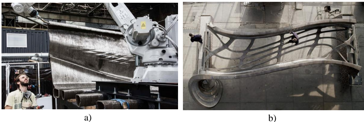
Slika 14. MX3D pješački most [21]: a) proces izrade, b) pogled iz zraka
