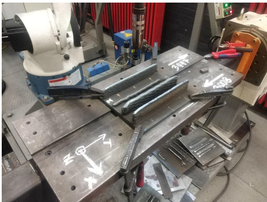
Slika 55. Izrađeni 2., 3. i 4. zid
