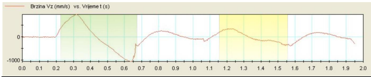
Slika 6.6 Dijagram brzine gibanja šasije
