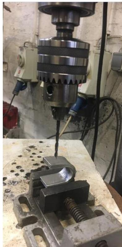
**Slika 43. Bušenje provrta na uzorcima**
