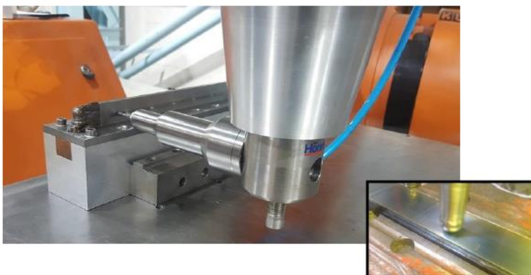
Slika 28. Prototip pneumatskog udubljivanja [46]
