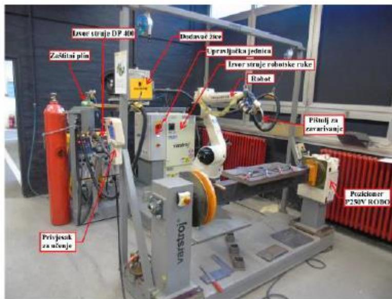
Slika 29. Robotska stanica Almega OTC AX V6 [36]
