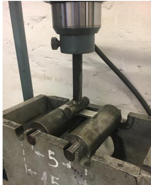
**Slika 42. Savijanje uzorka**
