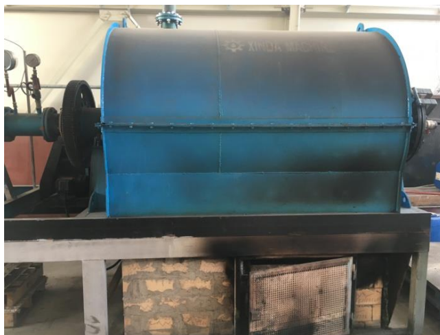
Slika 46. Reaktor pirolitičke peći
