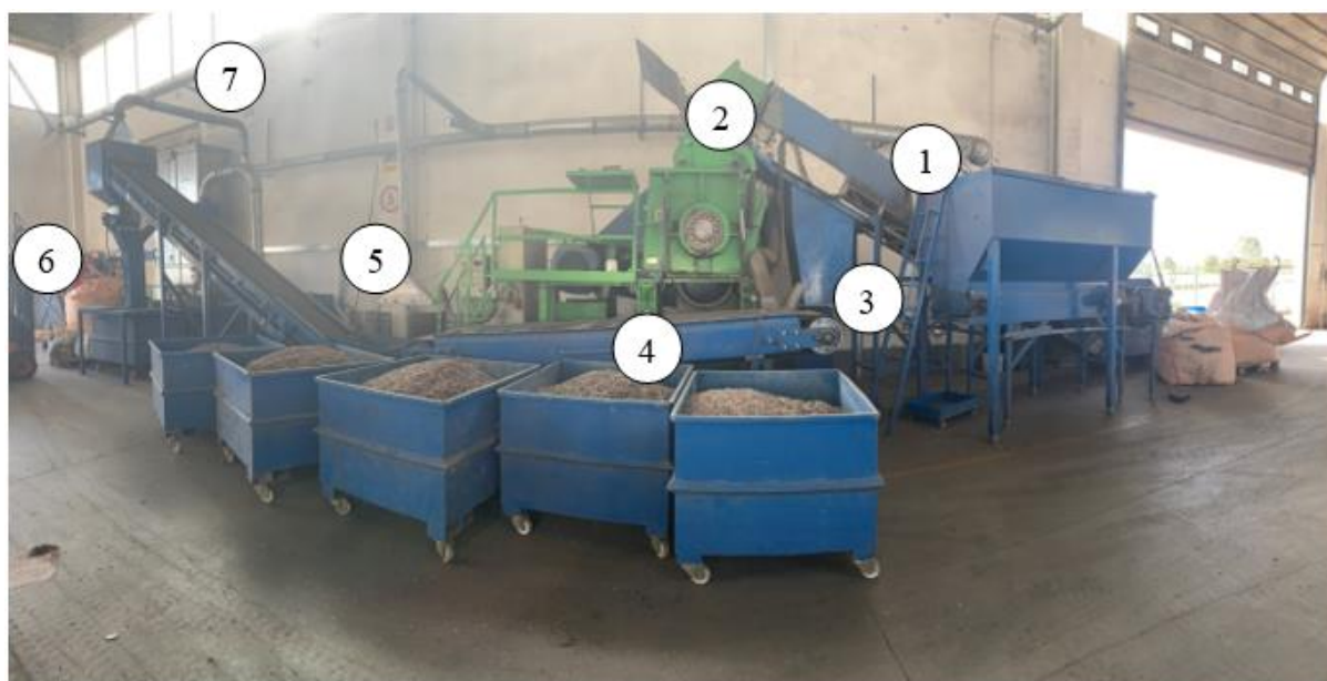
Slika 19. Procesna linija za usitnjavanje
