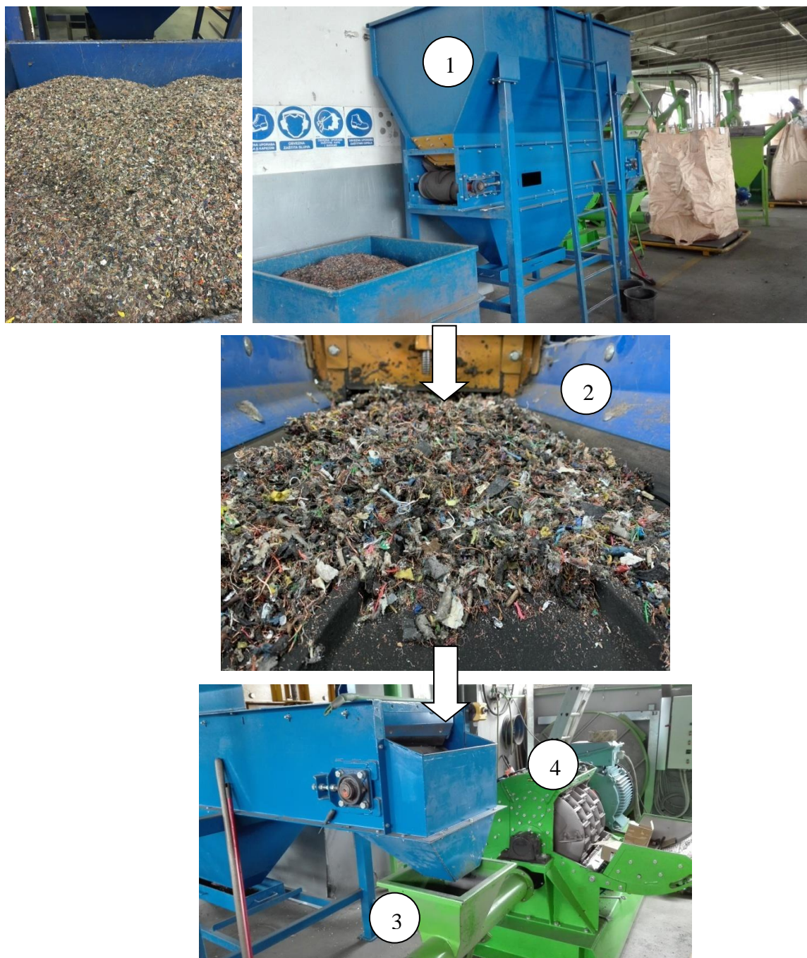
Slika 32. Ulaz materijala na liniji za separaciju
