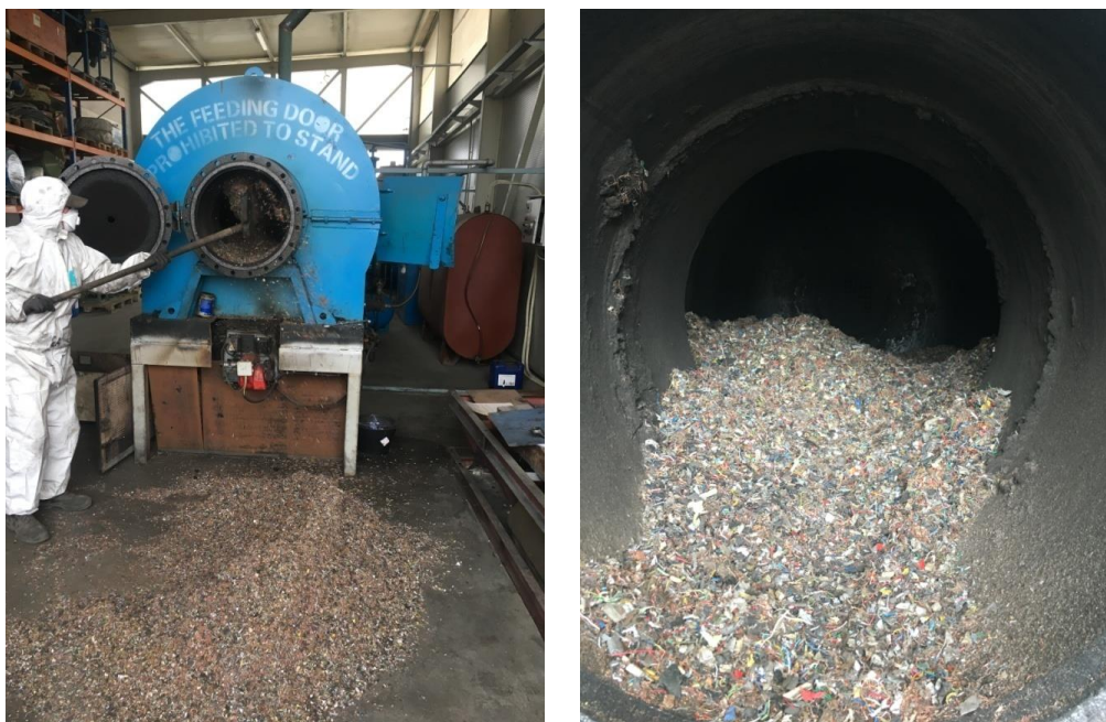
Slika 48. Ubacivanje materijala u reaktor
