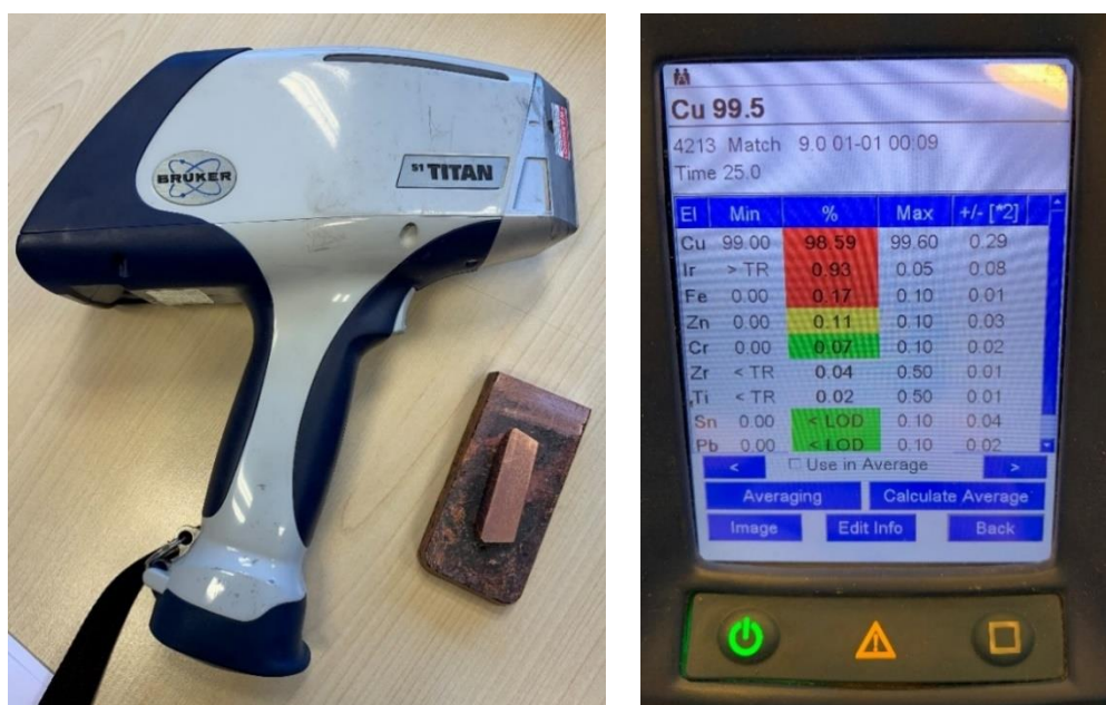
Slika 56. Ručni XRF spektrometar i dobivena analiza
