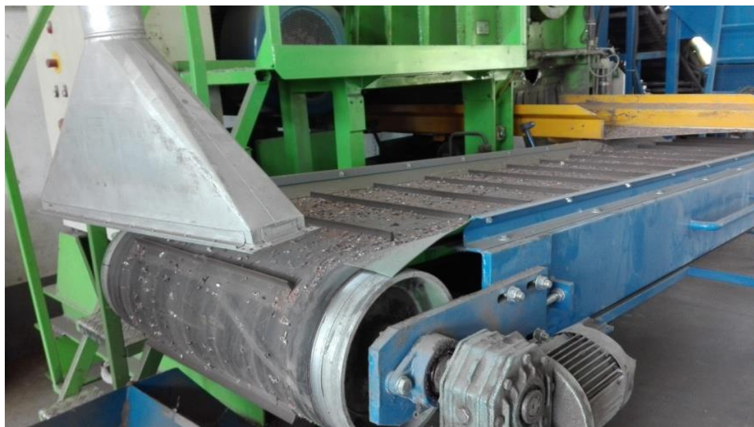
Slika 24. Magnetni valjak na kraju pokretne trake i usisna cijev za prašinu
