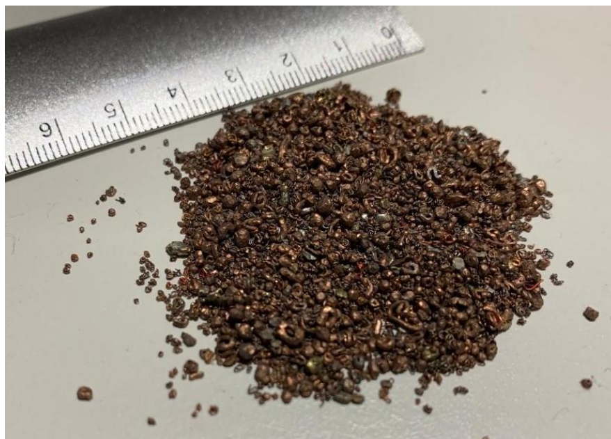
Slika 44. Granule bakra dobivene na liniji za separaciju
