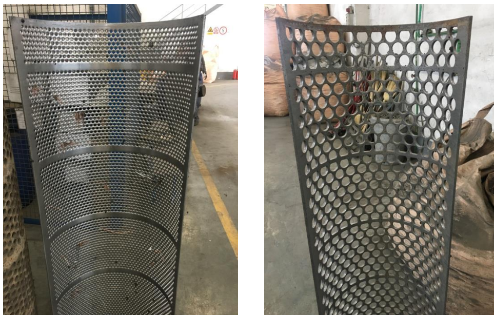
Slika 23. Varijabilna sita od 10 mm i 30 mm
