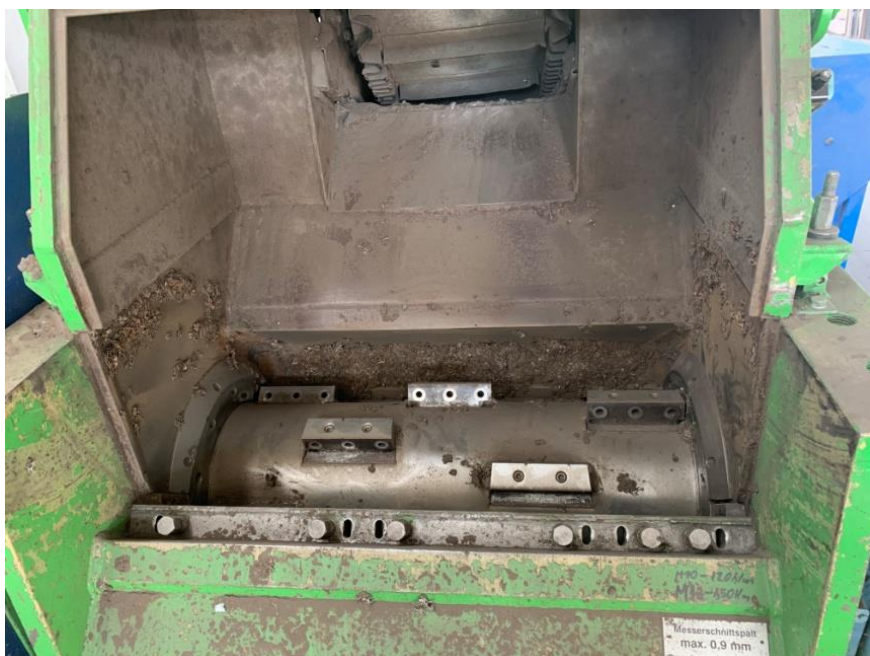
Slika 22. Unutrašnjost usitnjivača, noževi
