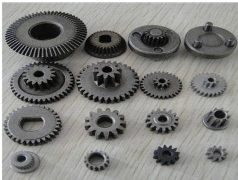
Slika 17. Primjena metalurgije praha [17]
