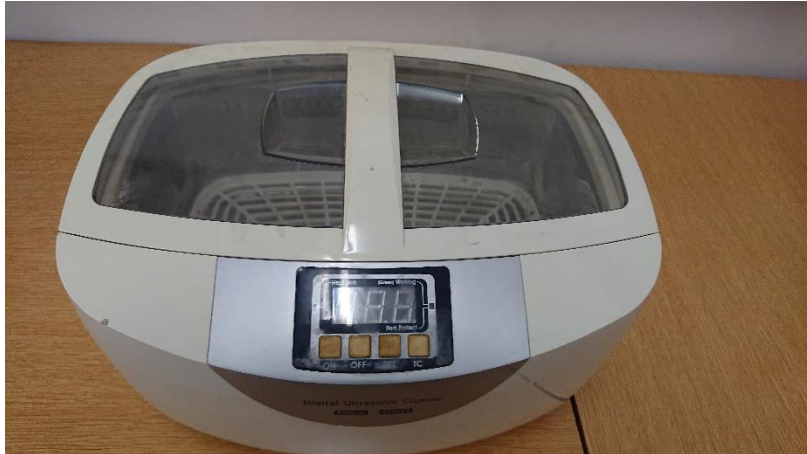
Slika 38. Ultrazvučna kupka za čišćenje uzoraka
