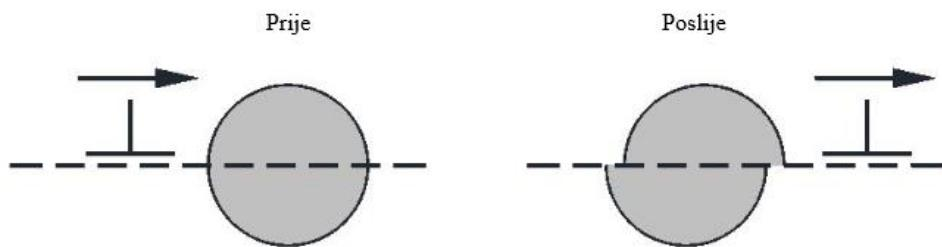
Slika 4. Gibanje dislokacija – rezanje precipitata [4]
