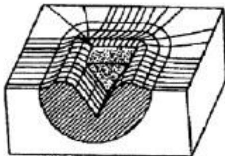
**Slika 12. Deformacija materijala izazvana mikrobratzanjem [8]**
