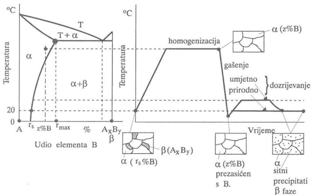
Slika 1. Postupak precipitacijskoga očvrsnuća [1]
