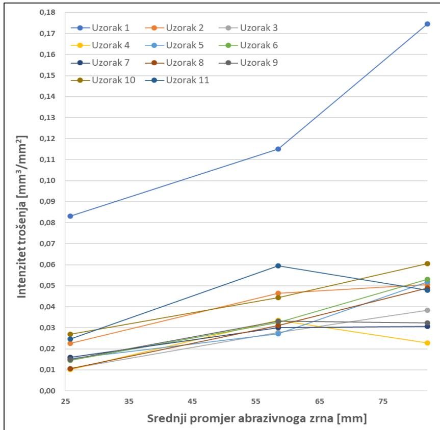
Slika 53. Ovisnost abrazijskoga trošenja o veličini abrazivnog zrna
