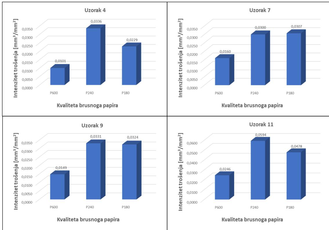
Slika 52. Trend trošenja uzorka s izraženom kritičnom veličinom abrazivnog zrna
