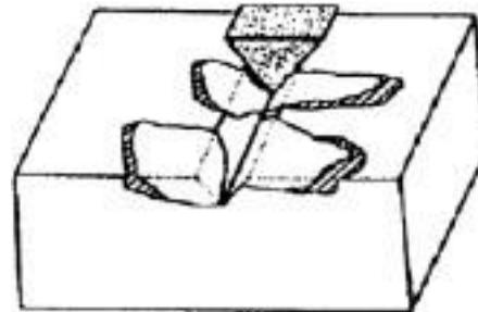
**Slika 14. Deformacija materijala izazvana mikronaprsnućima [8]**
