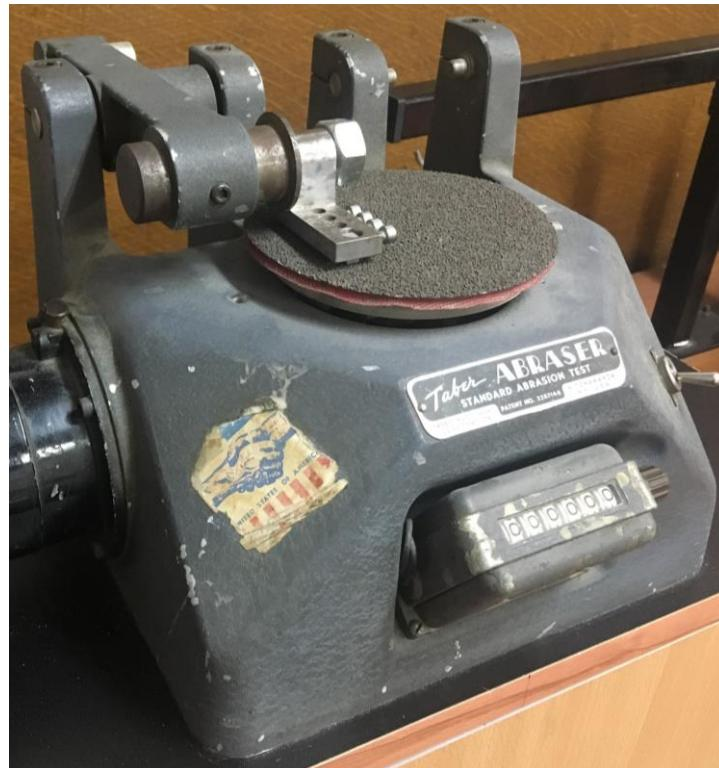
Slika 23. Uređaj za ispitivanje otpornosti na abrazijsko trošenje
