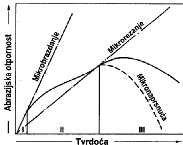
Slika 16. Ovisnost otpornosti na abrazijsko trošenje o tvrdoći materijala [9]
