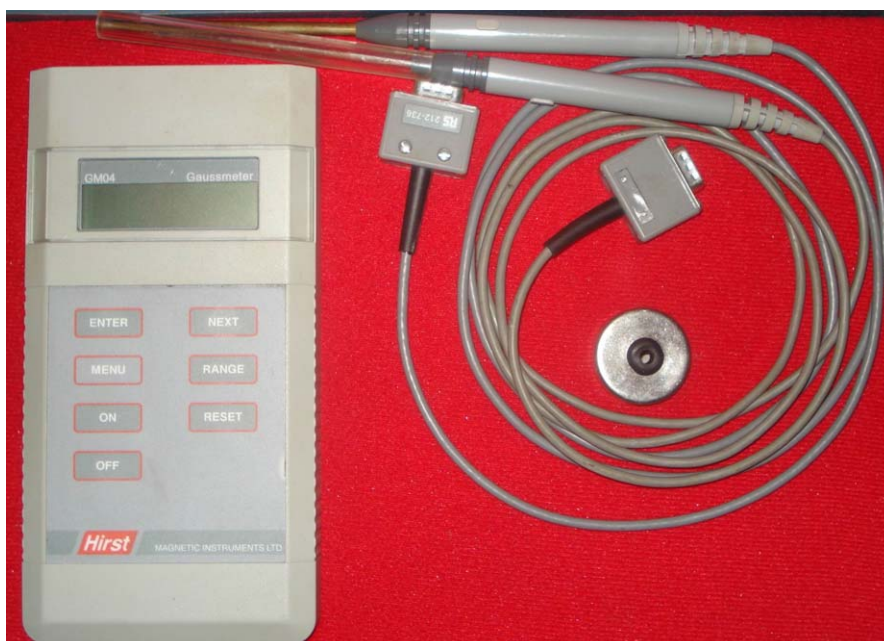
Slika 3.4. Uređaj za mjerenje jakosti magnetskog polja
