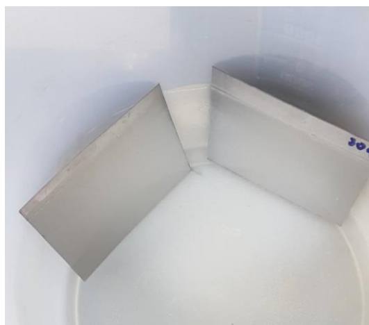
Slika 34. Uzorci čelika AISI 304L i AISI 316L u 3,5 % otopini NaCl
