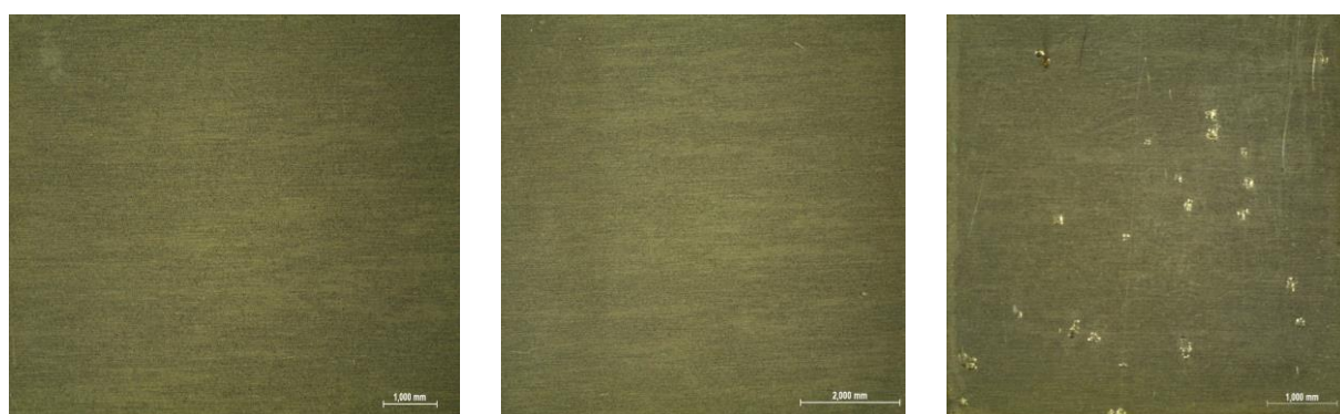
Slika 66. Stereomikroskopske snimke površine uzorka čelika AISI 316L tijekom elektrokemijskih ispitivanja u 3,5 % otopini NaCl s dodatkom H 2 O 2
