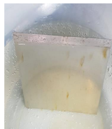
Slika 36. Napredovanje korozije čelika AISI 304L u 3,5 % otopini NaCl s dodatkom H 2 O 2
