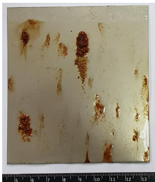
Prije uklanjanja korozivnih produkata
