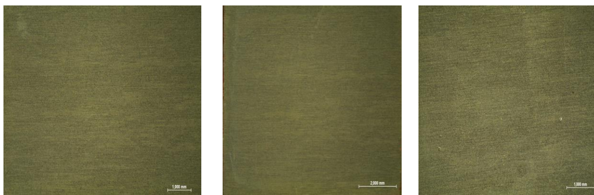
Slika 65. Stereomikroskopske snimke površine uzorka čelika AISI 316L tijekom elektrokemijskih ispitivanja u 3,5 % otopini NaCl
