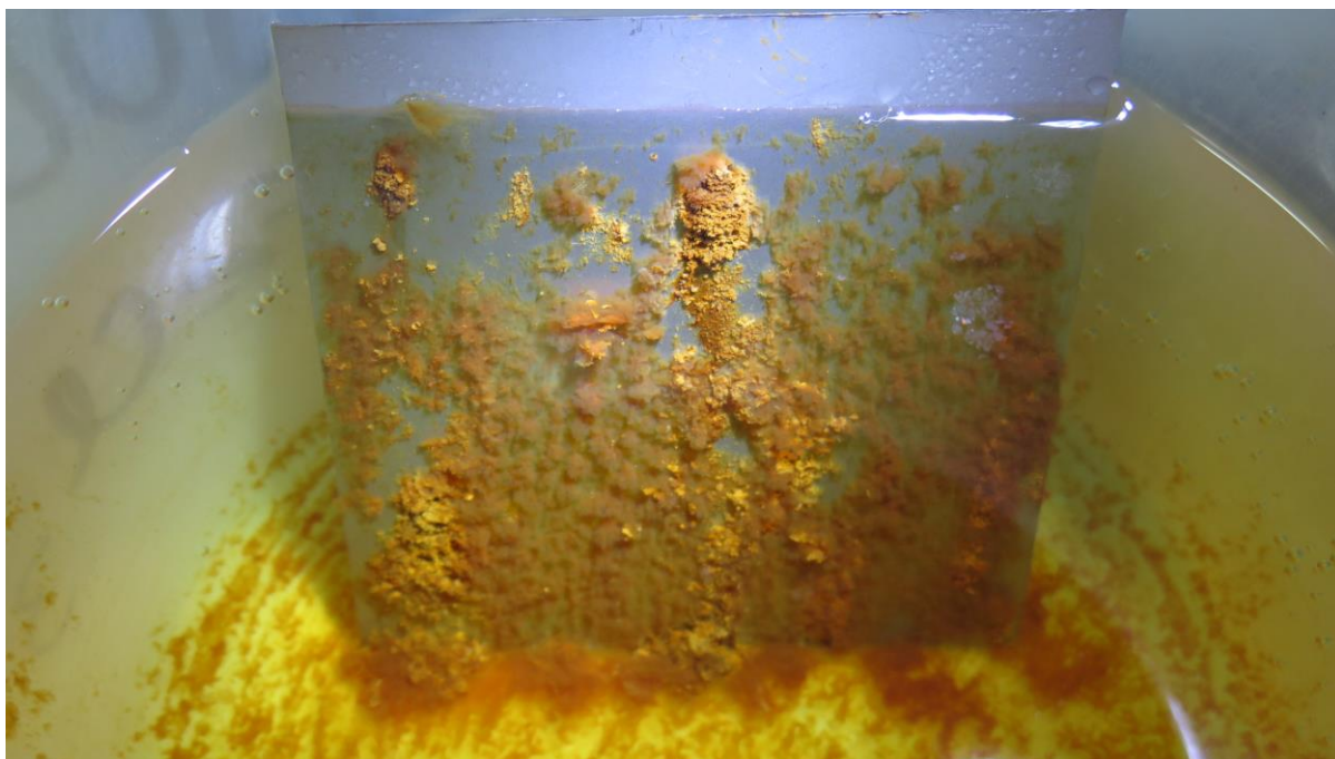
Slika 38. Detaljniji prikaz korozivskih produkata na čeliku AISI 304L
