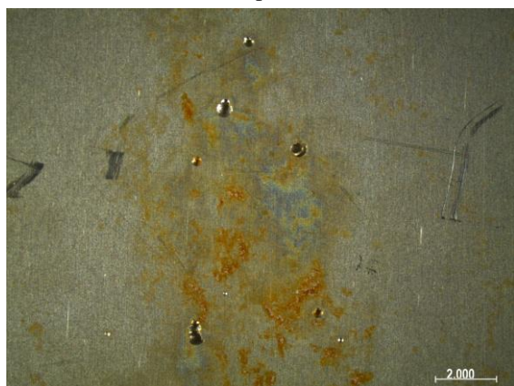
3,5% otopini NaCl s dodatkom H 2 O 2
