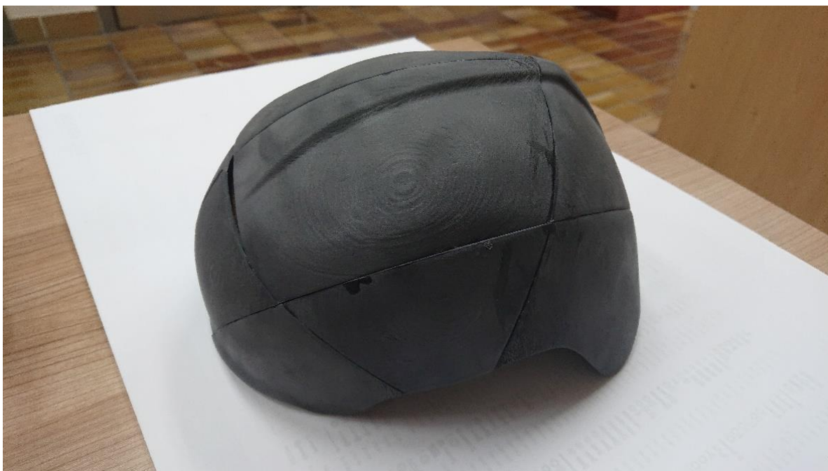
Slika 55. Kaciga tiskana postupkom SLS
