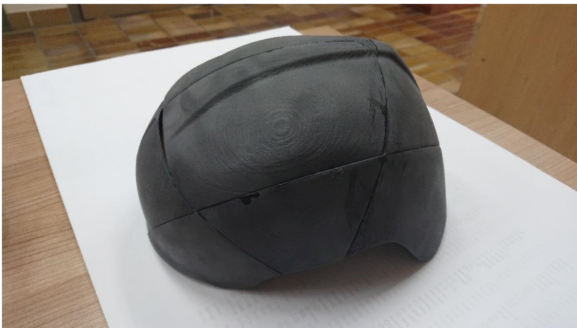
Slika 55. Kaciga tiskana postupkom SLS
