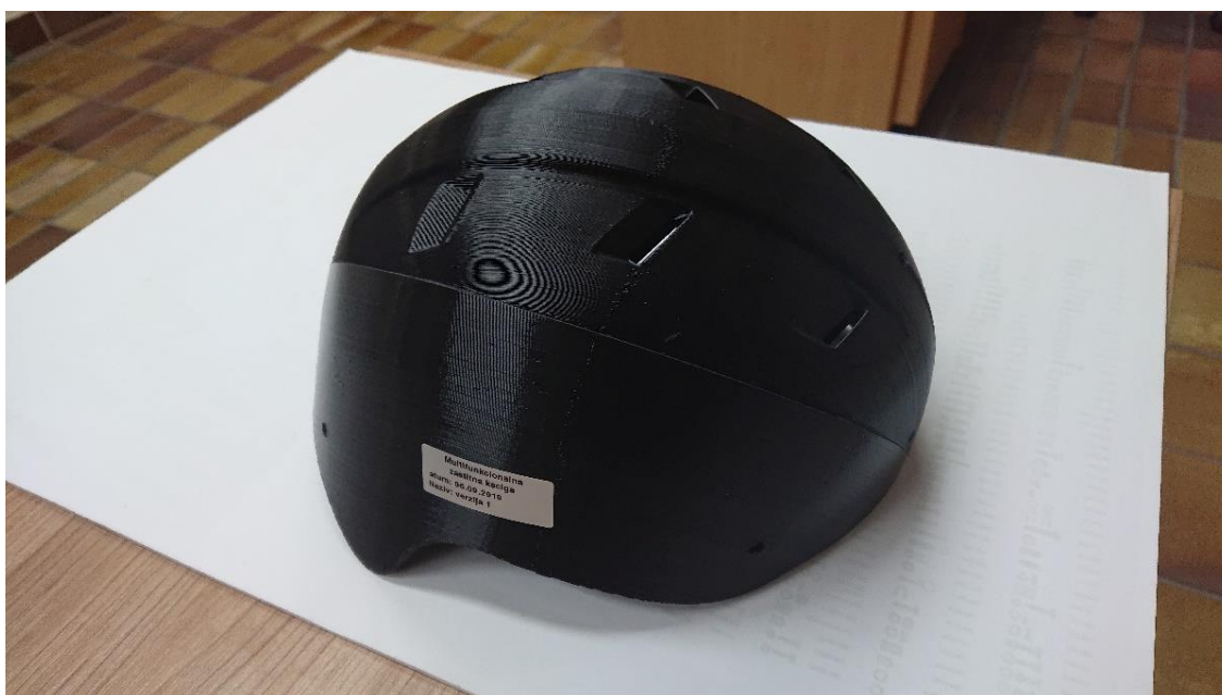
Slika 54. Crna kaciga tiskana postupkom LPD
