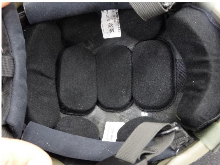
**Slika 27. Unutarnja oprema – spužvice**
