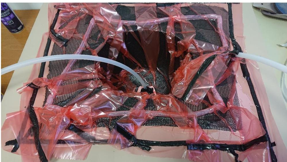
Slika 65. Postupak pod vakuumom
