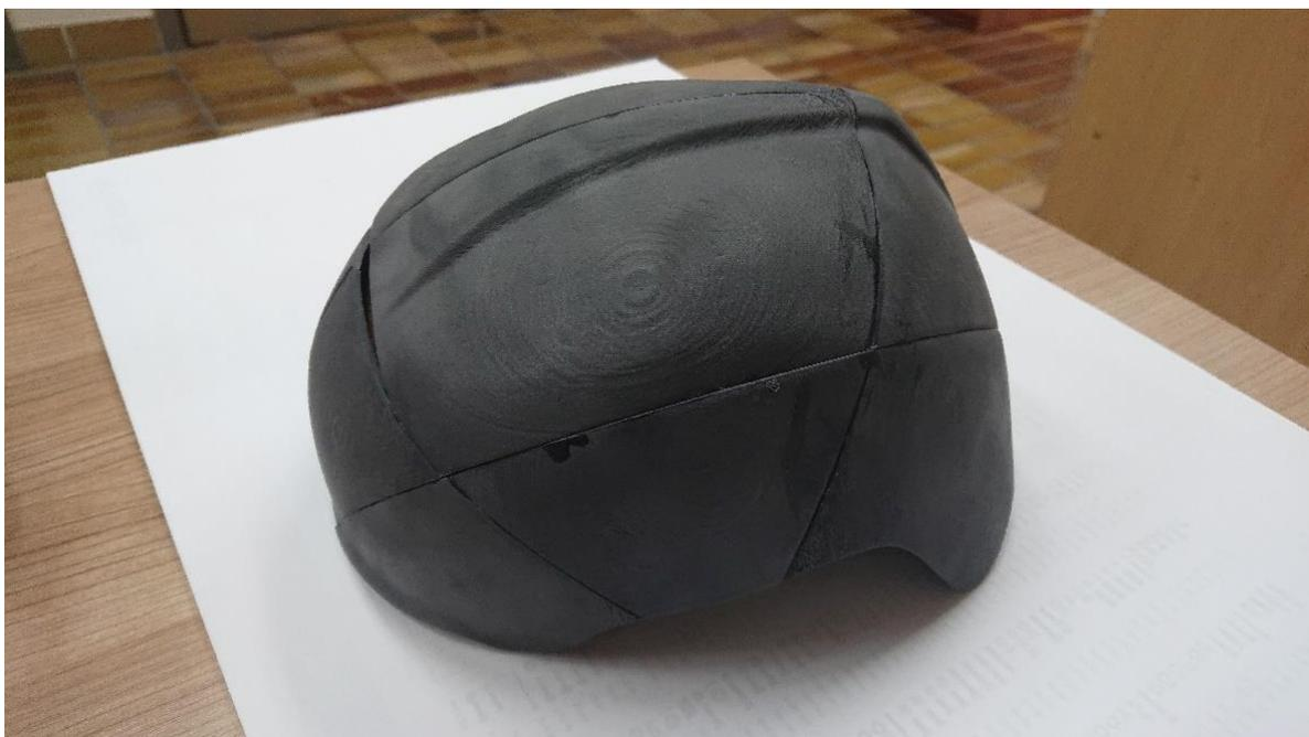
**Slika 55. Kaciga tiskana postupkom SLS**
