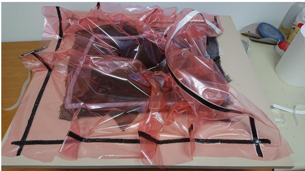
**Slika 64. Kalup spreman za postupak vakuumske infuzije**
