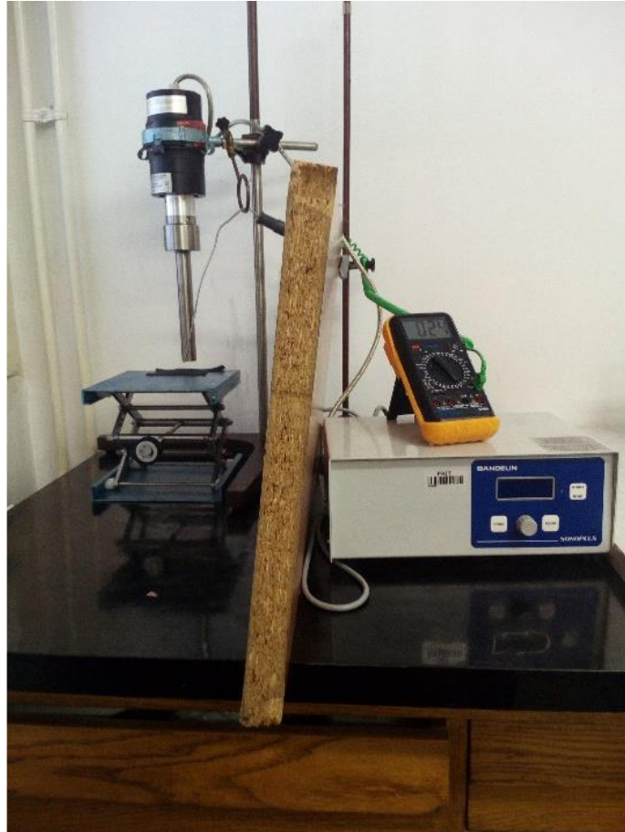
Slika 11. Prikaz aparature za ultrazvučnu homogenizaciju - Sonopuls HD 3400“
