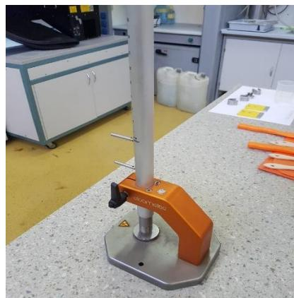
Slika 41. Uredaj za ispitivanje otpornosti na udar
