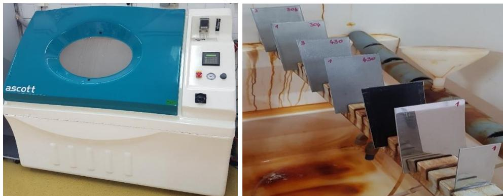
**Slika 36. Ispitivanje uzorka u slanoj komori**
