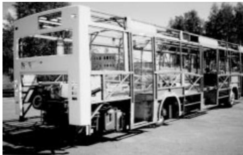
**Slika 20. Karoserija autobusa od nehrđajućeg čelika [12]**
