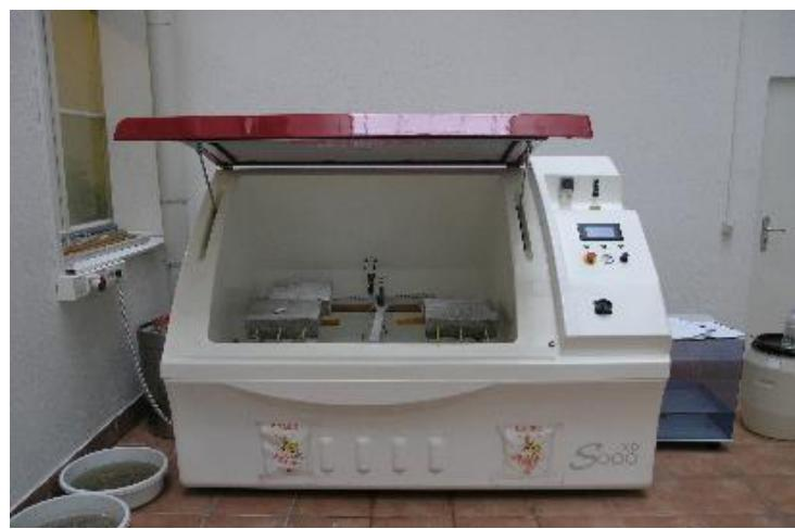
Slika 22. Slana komora za ubrzano korozjsko ispitivanje [21]
