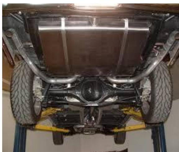
**Slika 17. Spremnik goriva od nehrđajućeg čelika [14]**
