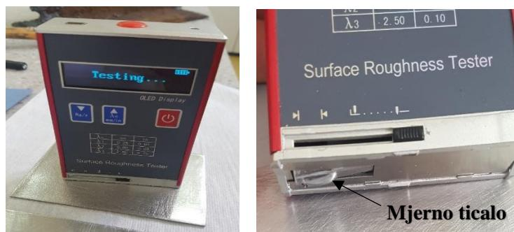
**Slika 30. Mjerni uređaj za ispitivanje hrapavosti**
