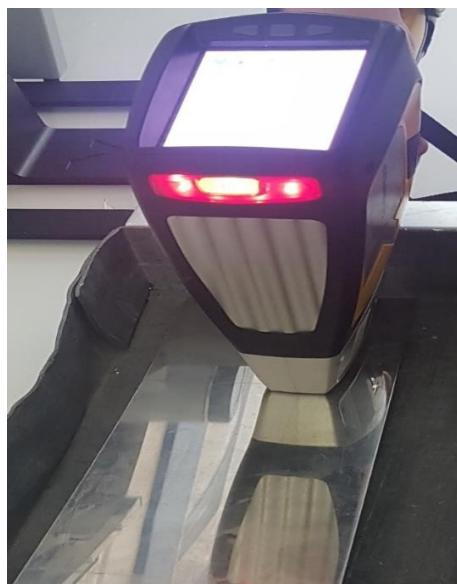
Slika 28. Ispitivanje kemijskog sastava XRF metodom
