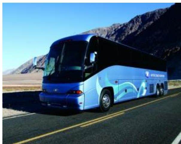
Slika 18. Karoserija MCI autobusa od nehrđajućeg čelika [15]
