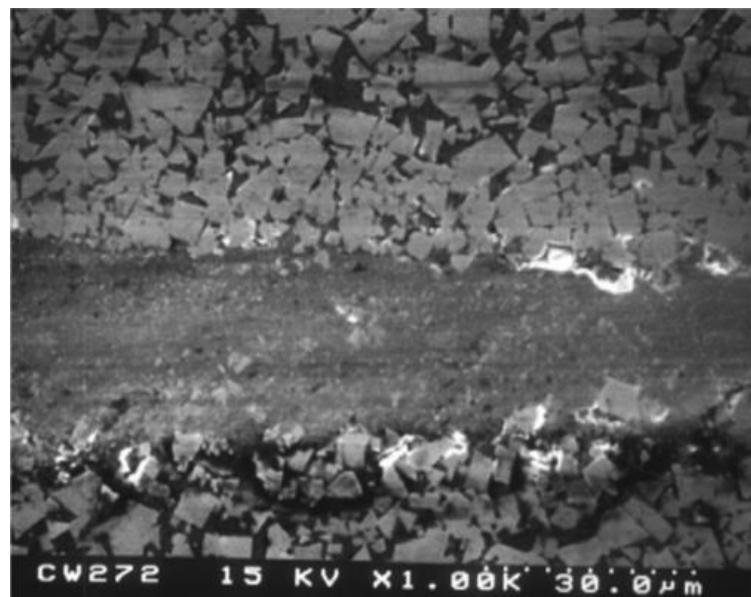
Slika 4.8. Površina WC-Co tvrdog metala s 20% Co nakon provednog testa brazdanja [31]
