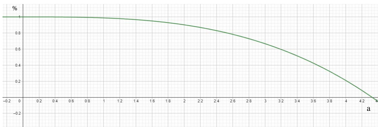
Slika 20. Redukcija u čvrstoći u ovisnosti o vrijednosti a
