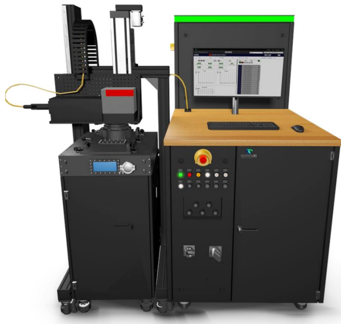
Slika 48. Aconity mini 3D printer za metal
