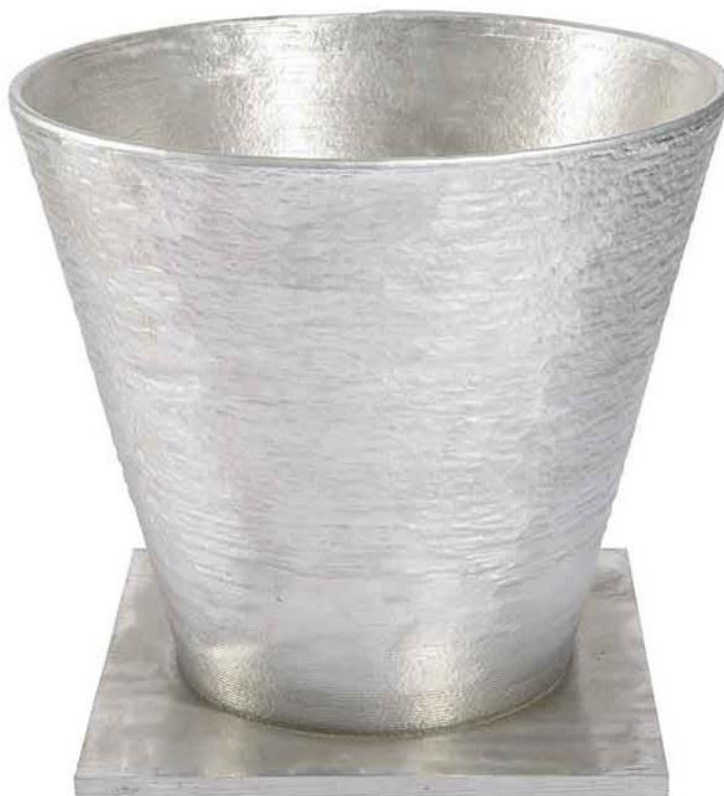
Slika 22 Stožac promjera 0,8 m izrađen WAAM tehnologijom [32]
