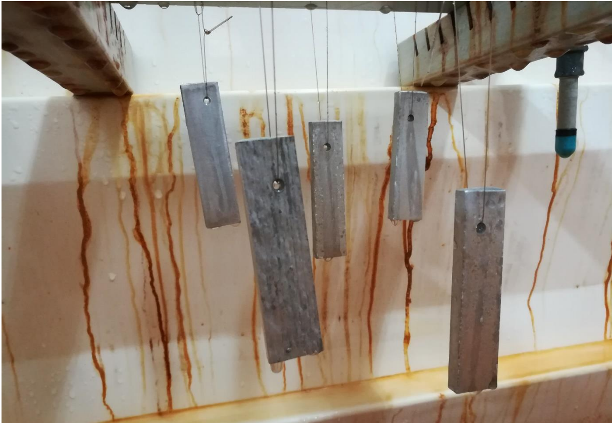
Slika 60 Uzorci postavljeni u slanu komoru
