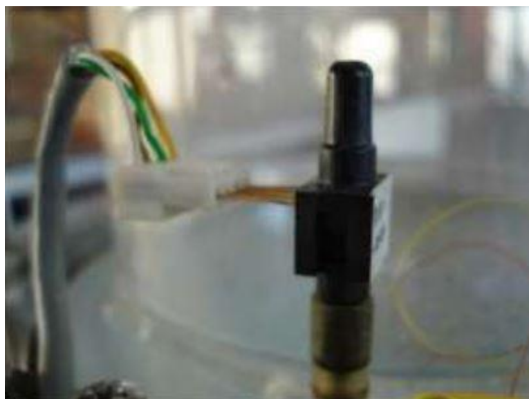
Slika 15. Osjetnik diferencijalnog tlaka PX26 – 001DV [3]
