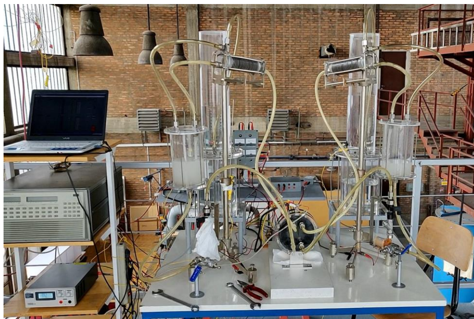
Slika 18. Sustav za proizvodnju vodika
