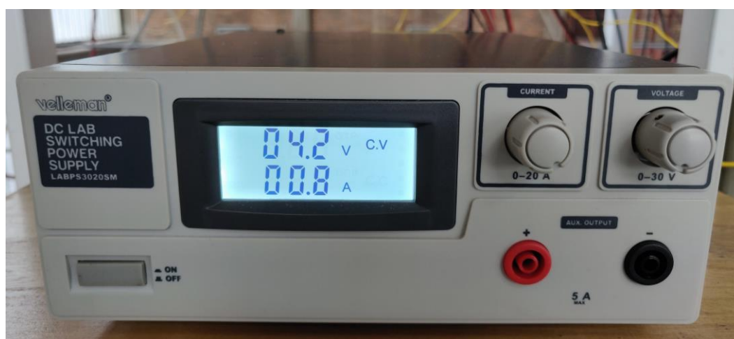
Slika 5. Laboratorijski izvor istosmjerne električne struje za pogon elektrolizatora
