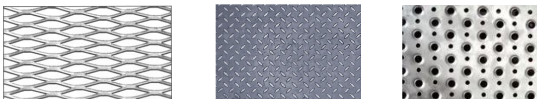
Slika 4.54 Ekspanzirani, rebrasti i perforirani lim
